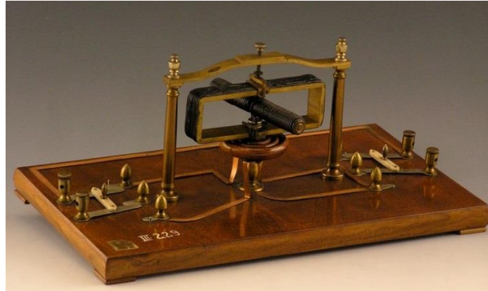
2. Ο πρώτος ηλεκτρικός κινητήρας που χρησιμοποιεί Ηλεκτρομαγνήτες ακίνητα και περιστρεφόμενα μέρη
