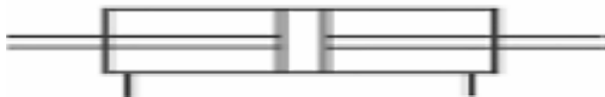
Εικόνα 4: Συμβολισμός κυλίνδρου με διπλό βάκτρο (Κωστόπουλος, 2009).
