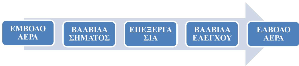
Σχήμα 1: Λογικό διάγραμμα ενός πνευματικού συστήματος (Σκαμπέλης & Κουμπούλης, 2015).
