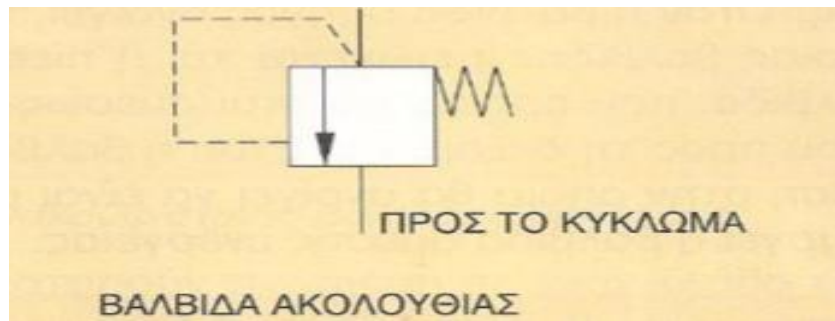
Εικόνα 26: Συμβολισμός βαλβίδα ακολουθίας ελέγχου πίεσης (Κωστόπουλος, 2009).
