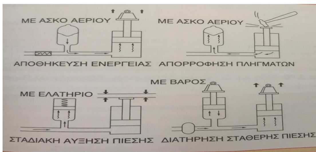
Εικόνα 30: Οι χρήσεις των υδραυλικών συσσωρευτών (Ρούτουλας, 2008).
