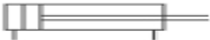
Εικόνα 3: Συμβολισμός κυλίνδρου με απλό βάκτρο (Κωστόπουλος, 2009).
