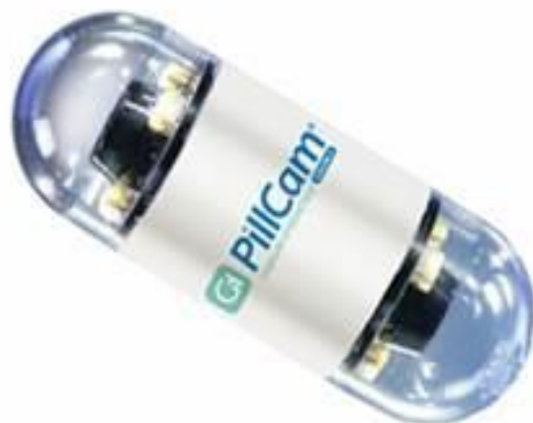
Εικόνα 36: Ηλεκτρονική κάψουλα ενδοσκόπησης. Ενδεικτικές διαστάσεις: Μήκος 1.5 cm και διάμετρος 0.9 cm.
