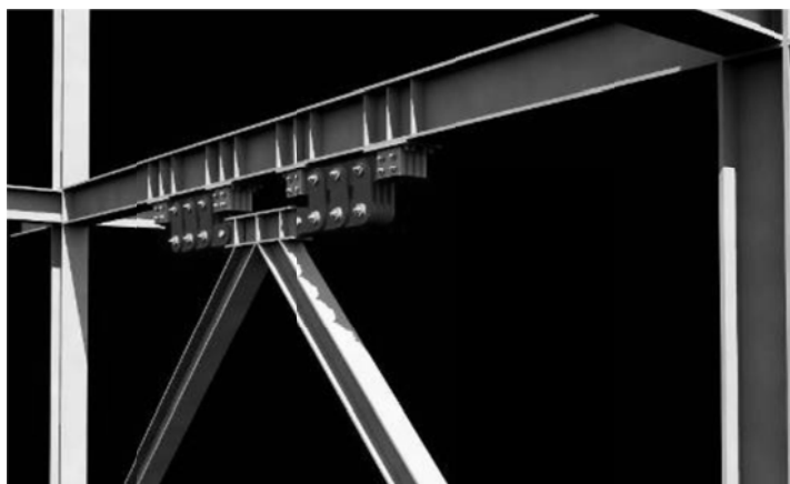
Σχήμα 2.26 Σύστημα αποσβεστήρων τοποθετημένοι σε σχήμα V (Mualla, 2018)
