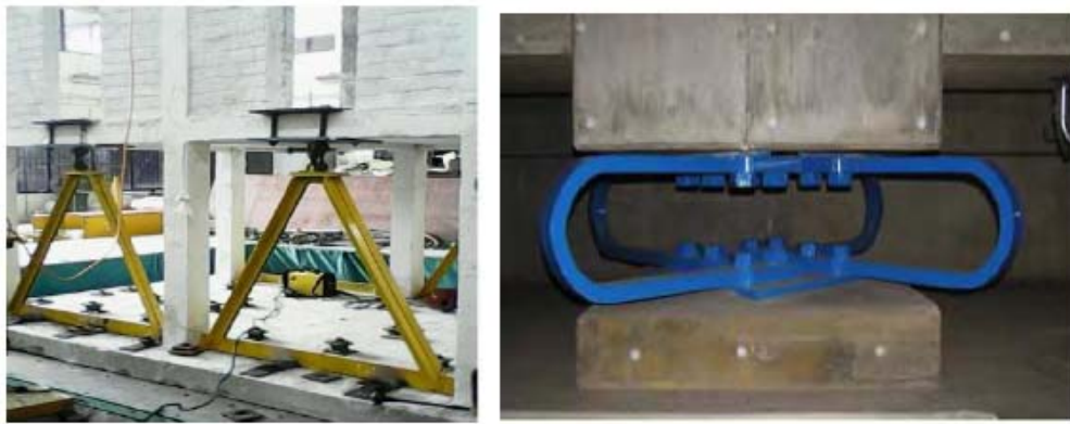
Σχήμα 3.12 Μεταλλικοί αποσβεστήρες τριγωνικής μορφής (αριστερά) και μορφής - U (δεξιά) (Χατζιράι, 2016 από www.ijetae.com & Jiao et al., 2014)
