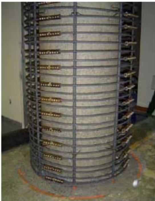
Σχήμα 2.46 Ενίσχυση υποστρώματος από σκυρόδεμα, πριν και μετά (Shao et al, 2004)
