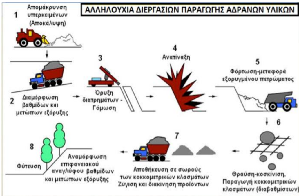
Εικόνα 2.4 Αλληλουχία διεργασιών για την παραγωγή αδρανών υλικών σε υπαίθριο λατομείο ( http://www.orykta.gr )
