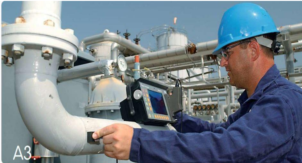
Εικόνα 1.3 έλεγχος με υπερήχους( http://www.acucert.gr/welcomeacucert/Acucert_cp.pdf σελ7)
