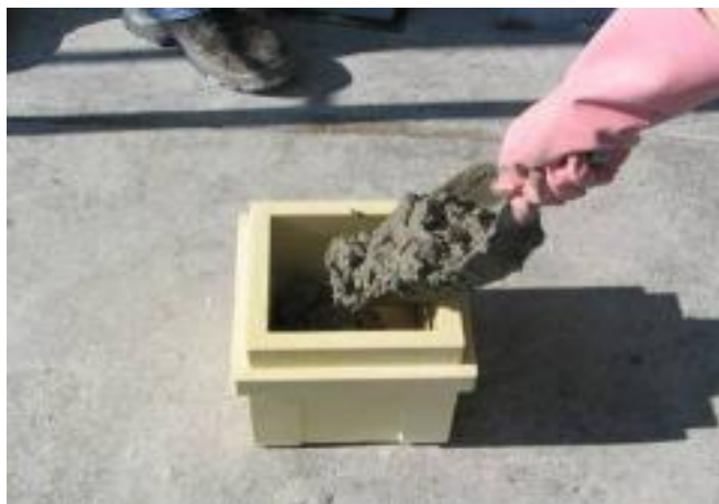
Εικόνα 5.4 Γέμισμα μήτρας( http://ggs.com.cy/images/resized/medium_picture55.jpg )
