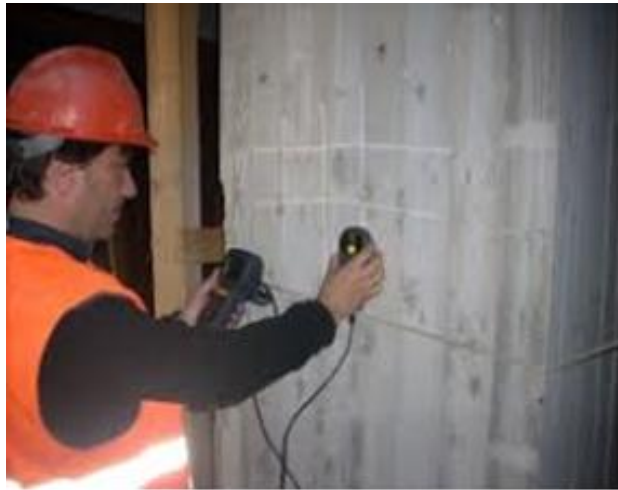
Εικόνα 1.4 έλεγχος με υπερήχους σε υποστύλωμα(www.geotest.gr)
