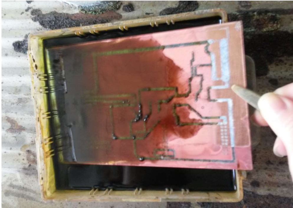
Εικόνα 51 : Αρχή αποχάλκωσης με διάλυμα τριχλωριούχου σιδήρου ( \text{FeCl}_3 ).
