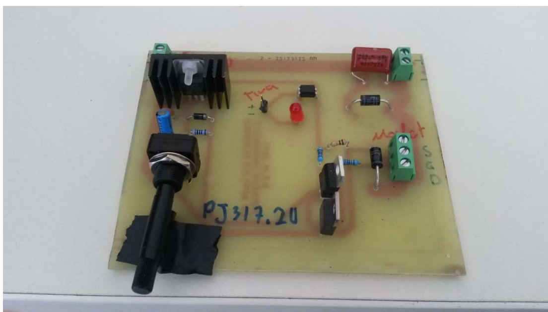
Εικόνα 54: Συναρμολόγηση πλακέτας ελέγχου.
