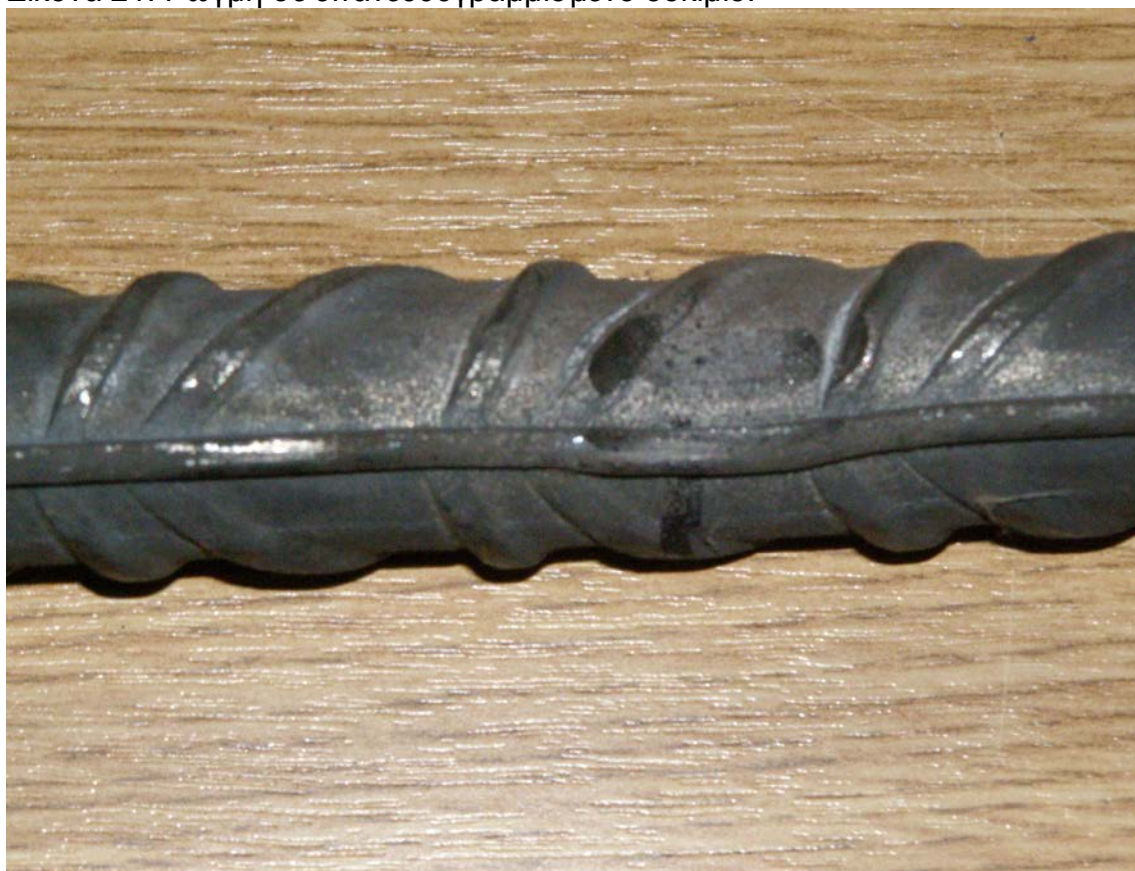
Εικόνα 21: Ρωγή σε επανευθυγραμμισμένο δοκίμιο.
