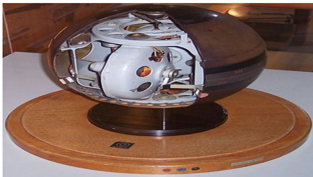
Εικόνα 5. Γυροσκοπική πυξίδα από τον εφευρέτη Herman Anschütz-Kaempfe το 1903
