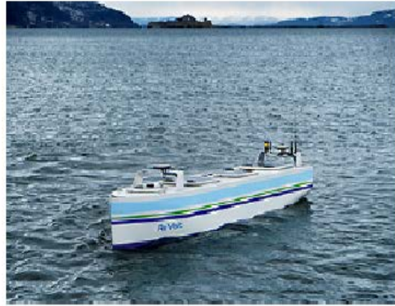
Εικόνα 25. Μοντέλο Re-Volt πειραματικής κλίμακας της DNV GL, που χρησιμοποιείται δοκιμαστικά από ερευνητές του πανεπιστημίου NTNU
