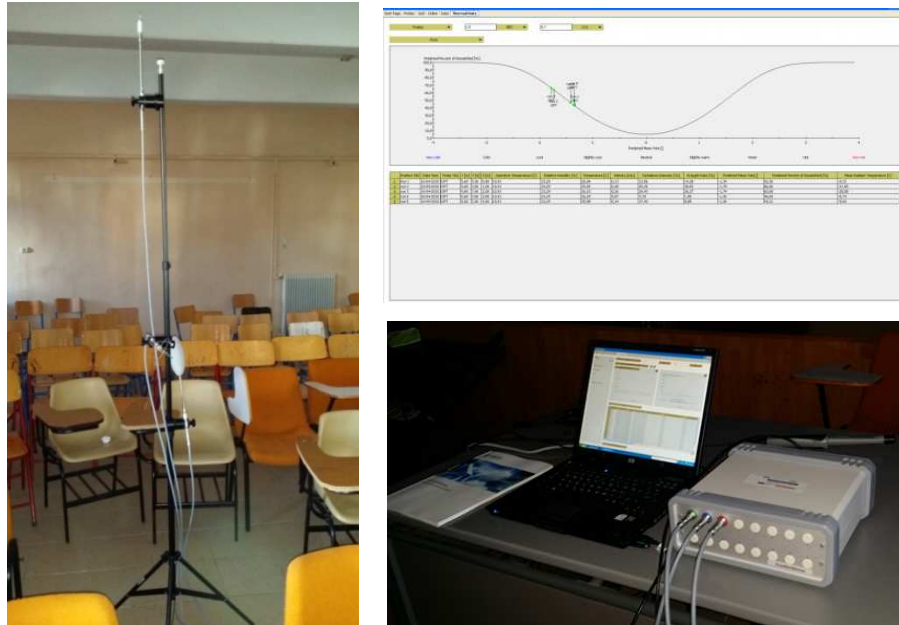
Σχήμα 1: Οι αισθητήρες έχουν συνδεθεί με καταγραφέα δεδομένων και το λογισμικό.
