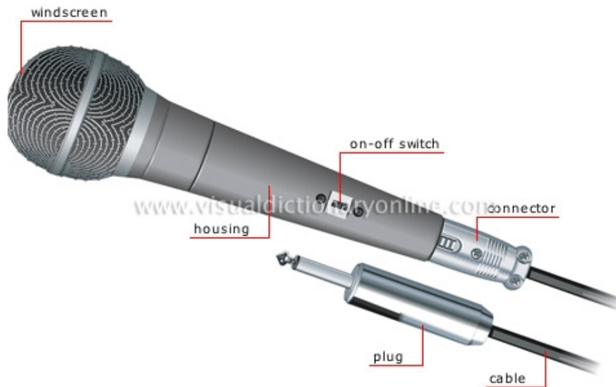
Εικόνα 3.2: Ένα δυναμικό μικρόφωνο
