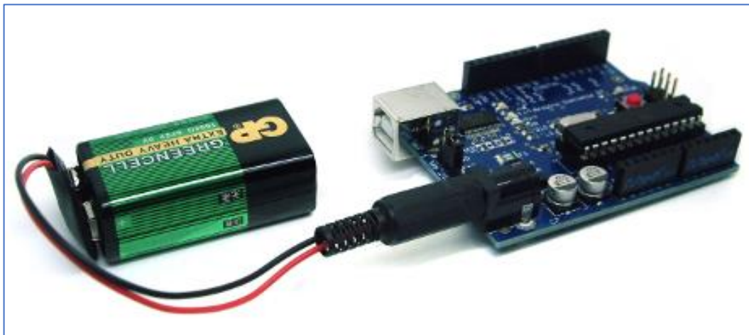
Σχήμα 2.5 – Περίπτωση τροφοδοσίας Arduino από μπαταρία
