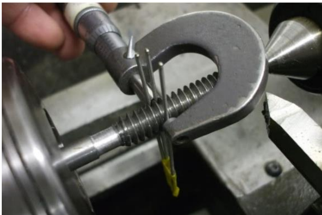
Εικόνα 43: Μέτρηση με τη μέθοδο συρματιδίων
