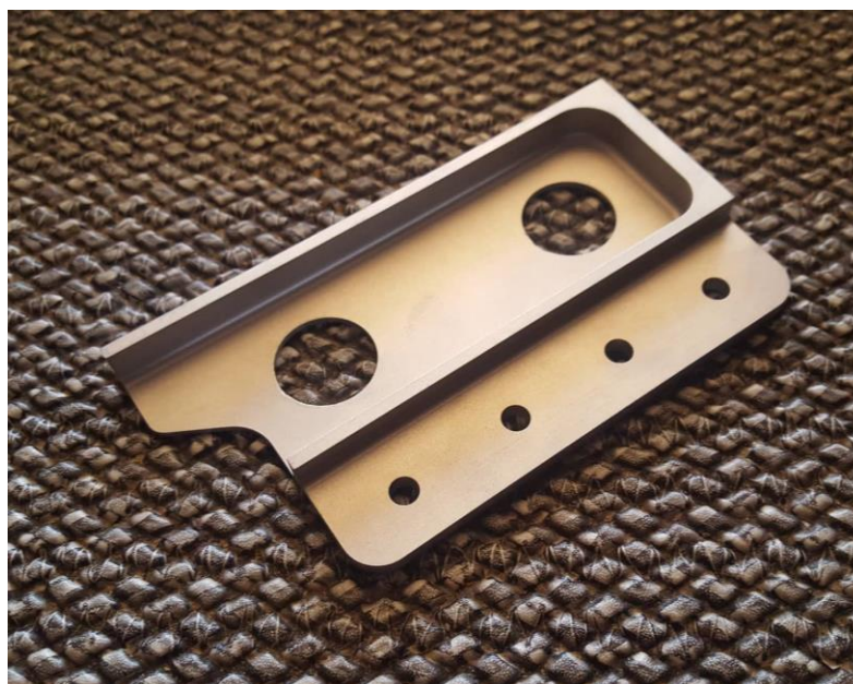
Εικόνα 9.6: Τελική μορφή δοκιμίου μετά την κατεργασία στη CNC φρέζα
