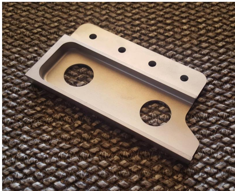
Εικόνα 9.5: Τελική μορφή δοκιμίου μετά την κατεργασία στη CNC φρέζα
