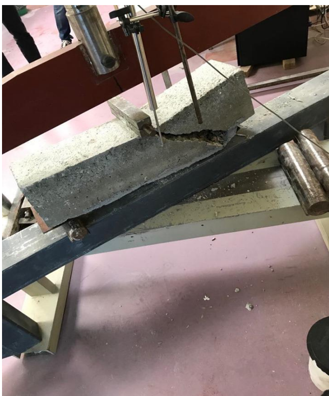
Εικόνα 6: Δοκίμιο με μεταλλικό έλασμα μετά την αστοχία
