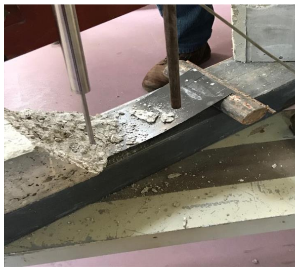
Εικόνα 5: Δοκίμιο με ανθρακοέλασμα μετά την αστοχία
