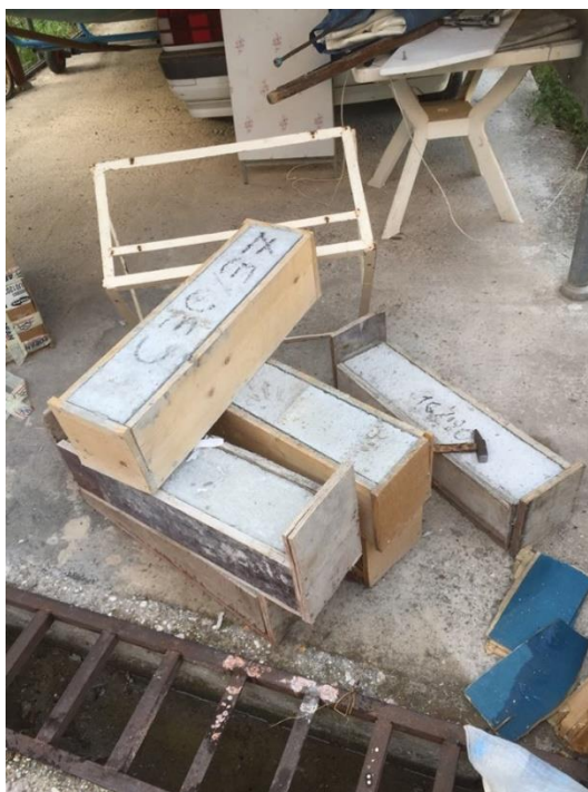
Εικόνα 1: Δοκίμια στα καλούπια μετά την ωρίμανση
