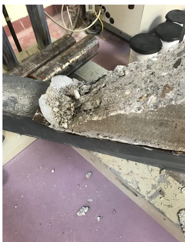
Εικόνα 7: Λεπτομέρεια αστοχίας δοκιμίου με μεταλλικό έλασμα
