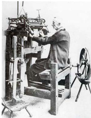
Εικόνα 1: Η πρώτη πλεκτομηχανή, Lee, 1589
