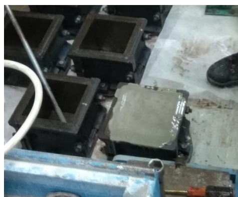
Εικόνα 4.19. Επιπέδωση επιφάνειας και αφαίρεση πλεονάζοντος υλικού
