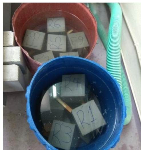
Εικόνα 4.24 Συντήρηση σε προσομοιωμένο θαλασσινό νερό
