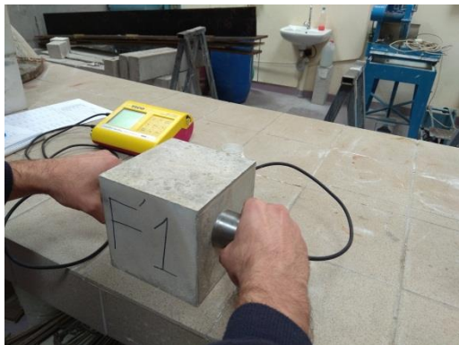
Εικόνα 4.25 Διαδικασία μετρήσεων με υπερήχους
