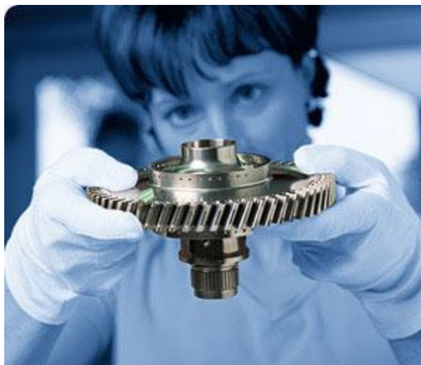
Εικόνα 3.1 Οπτικός Έλεγχος Βαθμίδος Μειωτήρα Στροφών (Καλκάνης & Καντεράκης, 2015)
