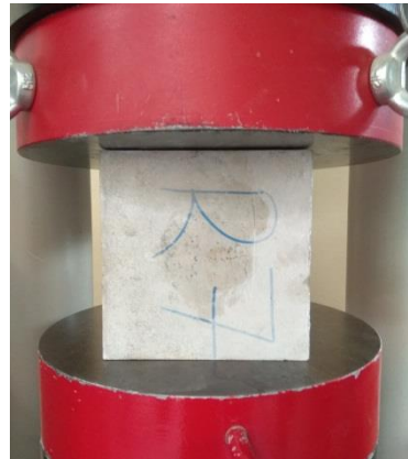
Εικόνα 4.26 Τοποθέτηση δοκιμίου στη συσκευή μονοαξονικής θλίψης
