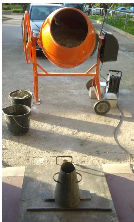
Εικόνα 4.3. Τοποθέτηση μπετονιέρας και συσκευών για δοκιμές
