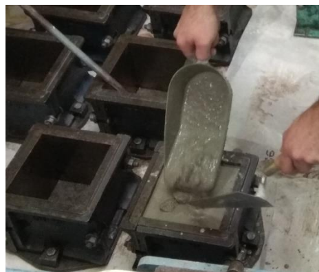
Εικόνα 4.17. Γέμισμα με τη δεύτερη στρώση
