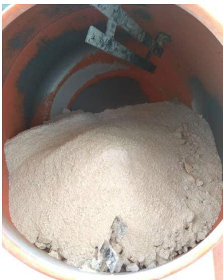
Εικόνα 4.6. Τοποθέτηση αδρανών στον κάδο ανάμειξης
