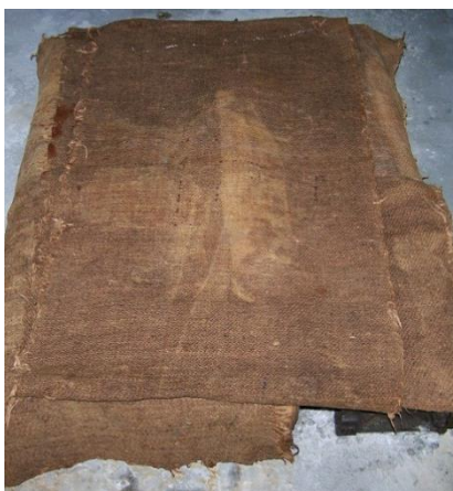
Εικόνα 4.20. Συντήρηση δοκιμών με βρεγμένη λινάτσα
