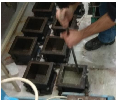
Εικόνα 4.16. Συμπύκνωση πρώτης στρώσης
