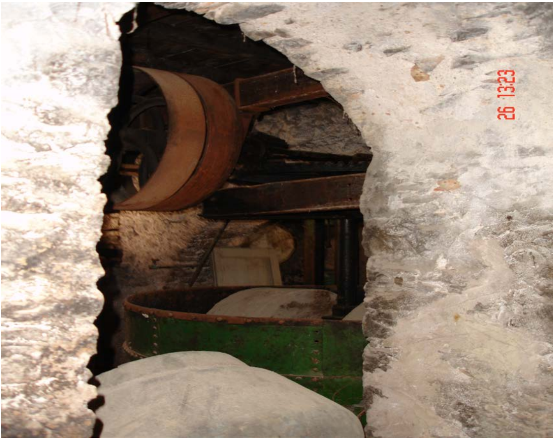
Ελαιόμυλος ή μάντρα με όλο το σύστημα το οποίο κινούνταν οι μυλόπετρες και εμφανή είναι τα γρανάζια και οι τροχαλίες ,από άλλη περιμετρική άποψη
