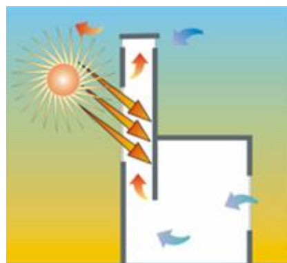
Εικόνα 12 Ηλιακή Καμινάδα Πηγή: http://www.cres.gr/energy_saving/Ktiria/fysikos_drosismos_fysikos_aerismos.htm
