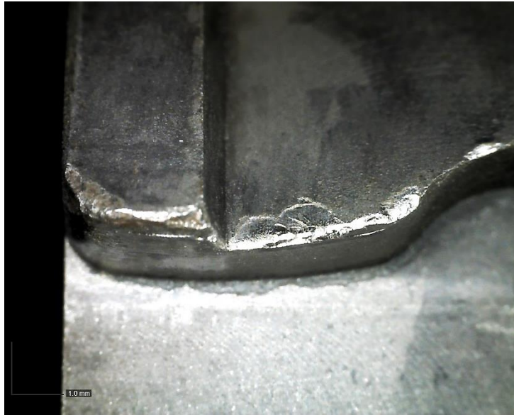
Εικόνα 7.26: Ακμή διαμόρφωσης εργαλείου – περιοχή δημιουργίας εφελκιστικής ινας – συναρμολόγημα QT+N1 (60x μεγέθυνση).
