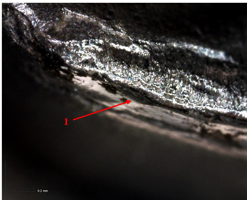
Εικόνα 7.36: Ακμή διαμόρφωσης εργαλείου – περιοχή δημιουργίας εφελκιστικής ίνας – συναρμολόγημα QT+N2 (230x μεγέθυνση).
