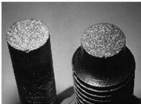
Εικόνα 1.10: Απεικόνιση επιφάνειας ψαθυρής θραύσης σε δοκίμιο εφελκυσμού. [15]
