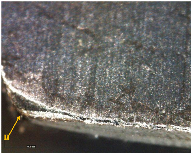
Εικόνα 7.4: Ακμή διαμόρφωσης του εργαλείου – περιοχή δημιουργίας εφελκυστικής ίνας – συναρμολόγημα Parent Assembly (230x μεγέθυνση).
