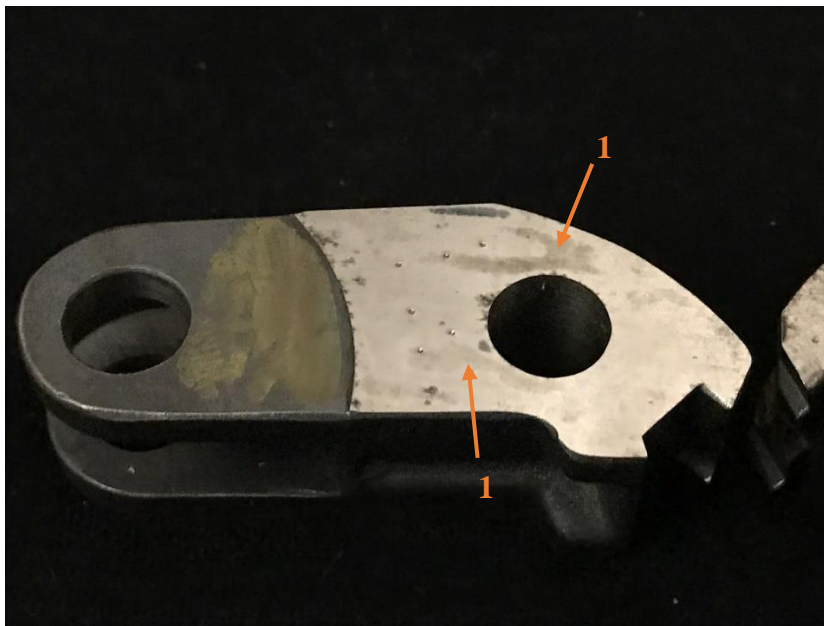
Εικόνα 6.5: Επιφάνεια του κινούμενου εξαρτήματος που υπέστη λείανση για αποπεράτωση – συναρμολόγημα Parent Assembly.
