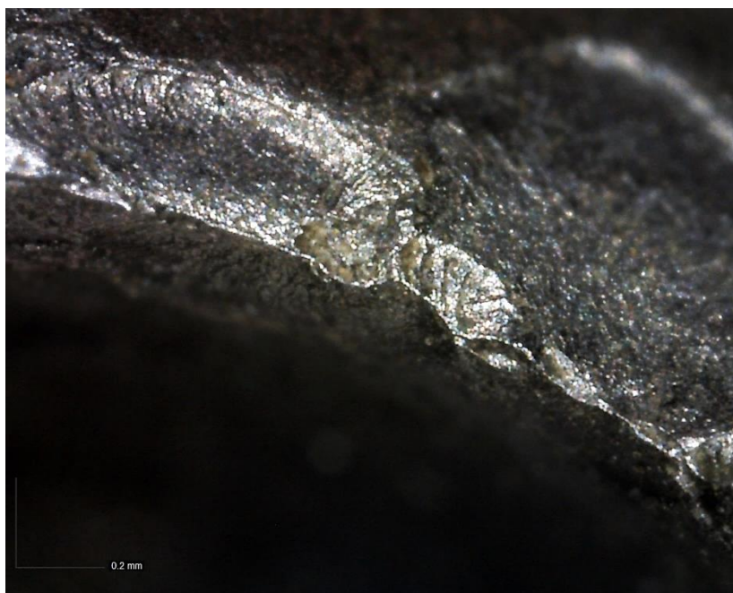
Εικόνα 7.35: Ακμή διαμόρφωσης εργαλείου – περιοχή δημιουργίας θλιπτικής ίνας, λεπτομέρεια 1 εικόνας 7.34 – συναρμολόγημα QT+N2 (230x μεγέθυνση).
