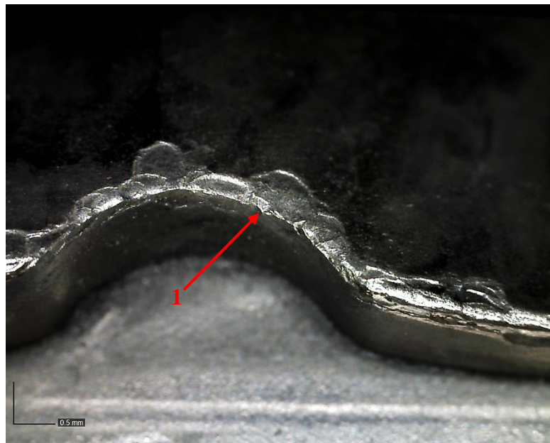
Εικόνα 7.34: Ακμή διαμόρφωσης εργαλείου – περιοχή δημιουργίας θλιπτικής ίνας – συναρμολόγηση QT+N2 (60x Μεγέθυνση).
