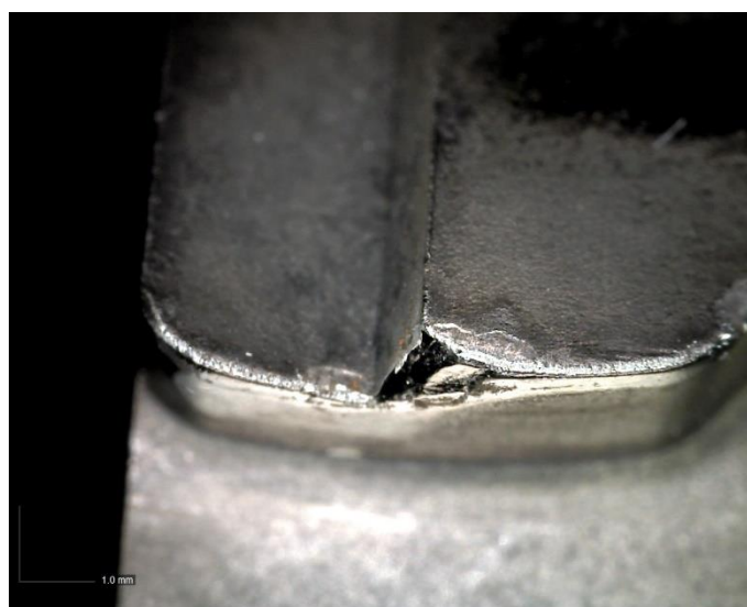
Εικόνα 7.23: Ακμή διαμόρφωσης εργαλείου – δημιουργίας εφελκιστικής ίνας, γειτονικά σημεία φθοράς – συναρμολόγημα N (230x μεγέθυνση).
