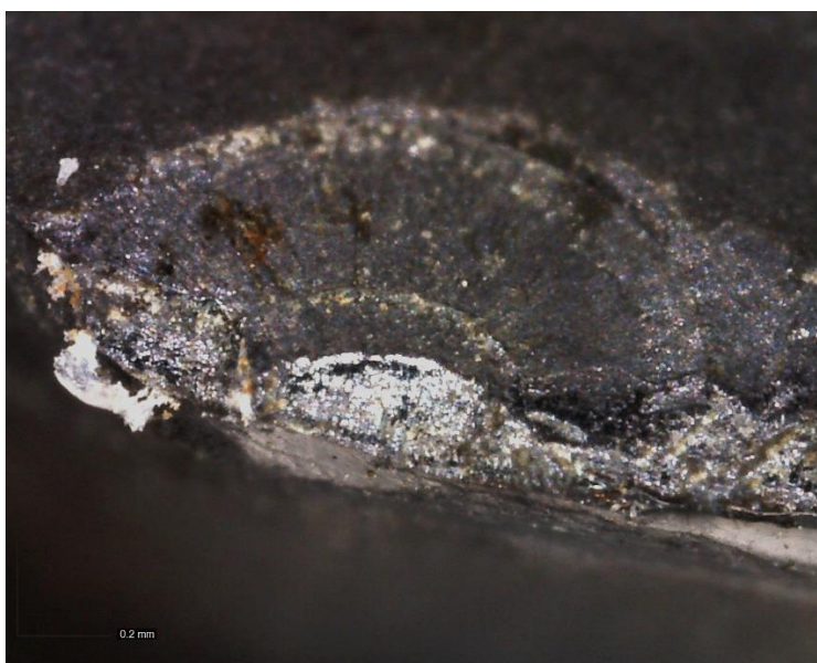
Εικόνα 7.28: Ακμή διαμόρφωσης εργαλείου – περιοχή δημιουργίας εφελκιστικής ινας – συναρμολόγημα QT+N1 (190x μεγέθυνση).
