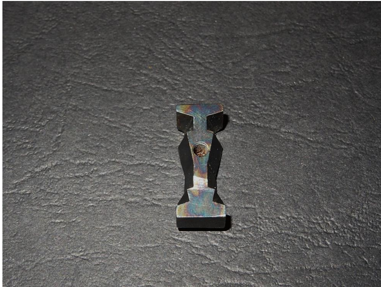
Εικόνα 6.7: Γενική άποψη του σταθερού εξαρτήματος του εργαλείου μορφοποίησης – συναρμολόγημα 1 st Attempt.
