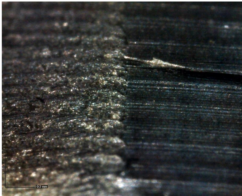
Εικόνα 7.12: Ελλειπής μηχανουργική κατεργασία – κατατομή της κεφαλής της σιαγόνας (ΔΕ) – συναρμολόγημα 1 st Attempt (230x μεγέθυνση).
