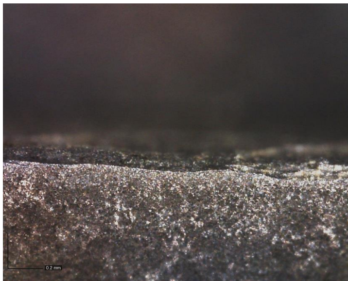
Εικόνα 7.27: Ακμή διαμόρφωσης εργαλείου – αλλοίωση της επιφάνειας κατά μήκος της ακμής – συναρμολόγημα QT+N1 (210x μεγέθυνση).
