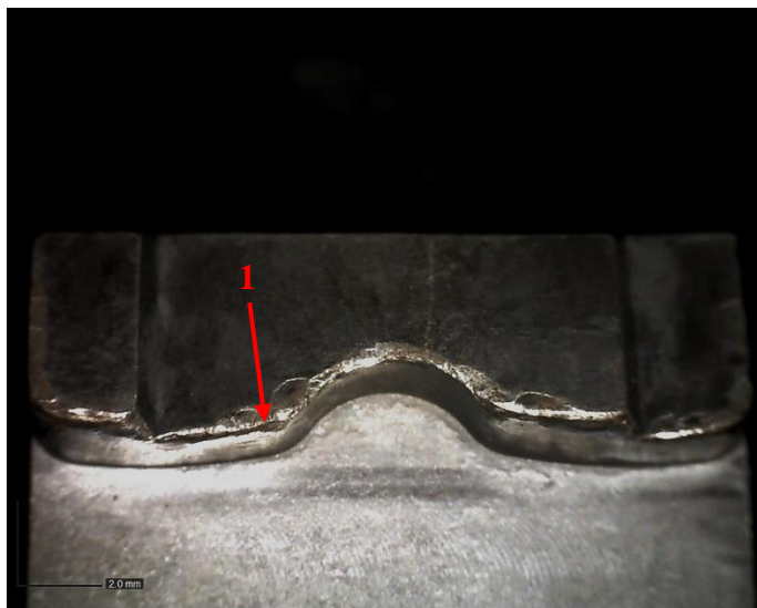
Εικόνα 7.29: Περιοχή διαμόρφωσης – κεφαλή σιαγόνας (ΔΕ) - συναρμολόγημα QT+N1 (30x μεγέθυνση)
