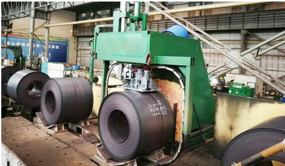
Εικόνα 4.3: Απεικόνιση αυτόματης μηχανής συνάρμοσης μεταλλικού ελάσματος με σκοπό την συσκευασία κουλούρων μεταλλικής λαμαρίνας [42].
