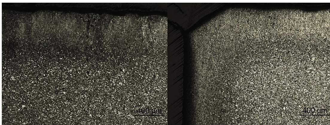
Εικόνα 12.4: Απεικόνιση της πλαστικής παραμόρφωσης από σφυρηλάτηση του κινούμενου μέρους (ΔΕ) σε μεγέθυνση x50 – συναρμολόγημα Parent Assembly.
