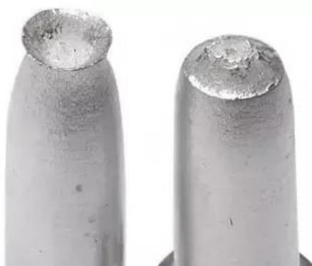
Εικόνα 1.9: Απεικόνιση όλκιμης θραύσης σε δοκίμιο εφελκυσμού. Φαίνεται η δημιουργία λαιμού η μείωση διατομής και η τελική διαμόρφωση του δοκιμίου (cup and cone). [14]
