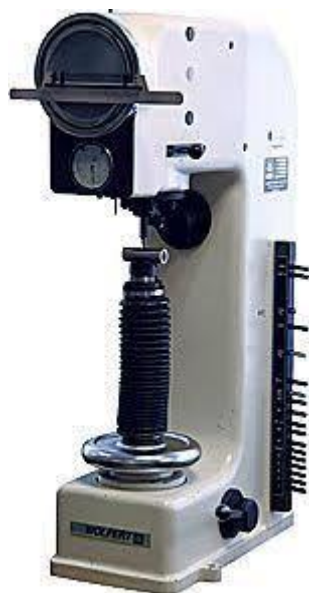
Εικόνα 11.8: Απεικόνιση σκληρόμετρου WILSON WOLPERT DIATESTOR 2RC. [49]
