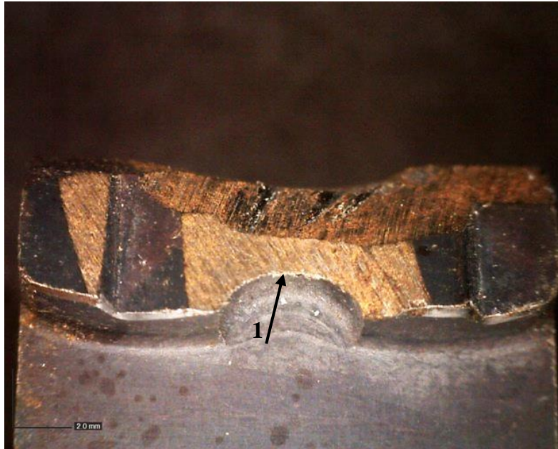
Εικόνα 7.6: Περιοχή διαμόρφωσης – κεφαλή σιαγόνας (ΔΕ) – συναρμολόγημα Parent Assembly (30x μεγέθυνση).
