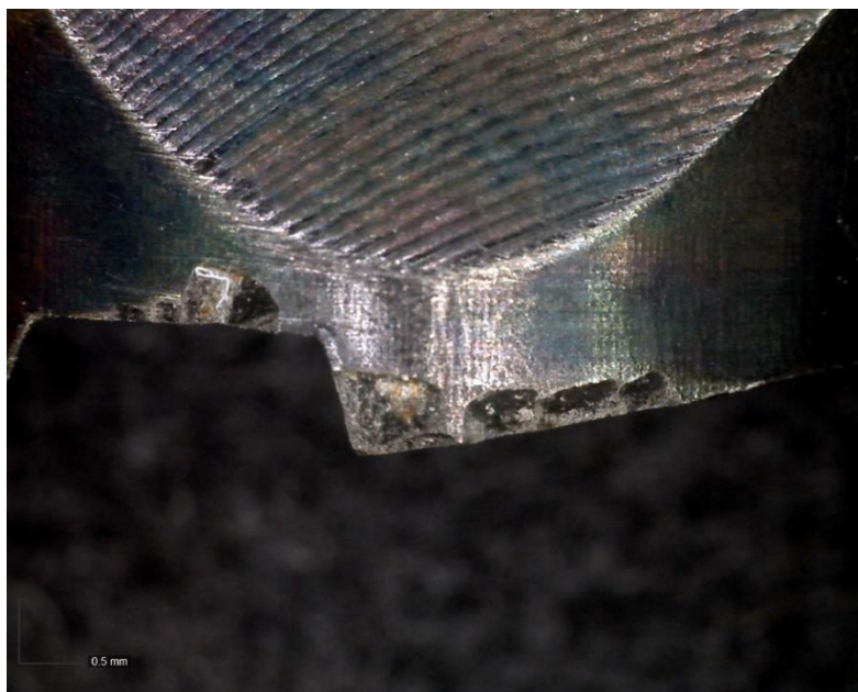
Εικόνα 7.17: Σταθερό εξάρτημα διαμόρφωσης – απεικόνιση αποκολλήσεων και θραύσεων στην ακμή λειτουργίας 1 st Attempt. (60x Μεγέθυνση).
