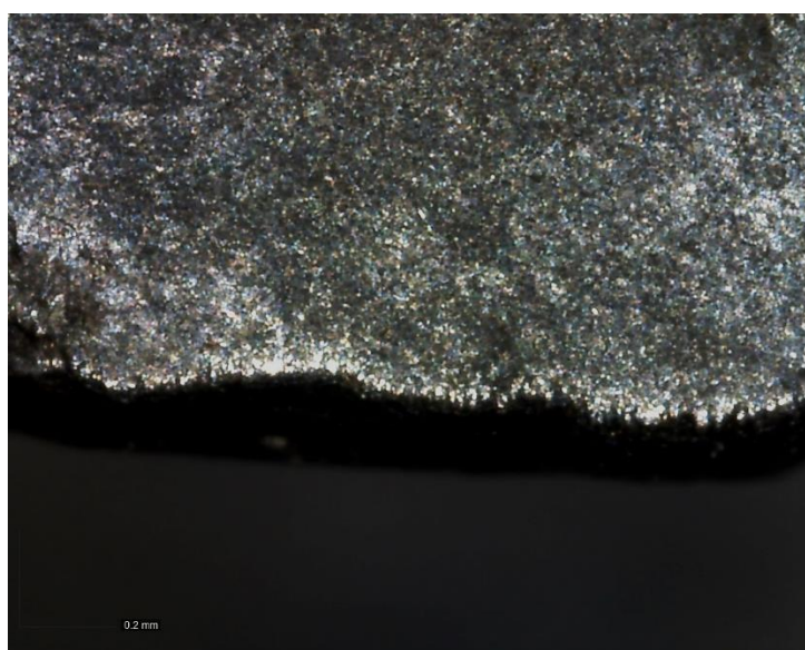
Εικόνα 7.30: Ακμή διαμόρφωσης εργαλείου – περιοχή δημιουργίας θλιπτικής ινας – συναρμολόγημα QT+N1 (230x μεγέθυνση).
