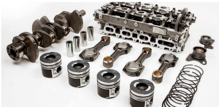
Εικόνα 2.2: διάφορα εξαρτήματα μηχανής αυτοκίνητου κατασκευασμένα από χάλυβα κατασκευών.
