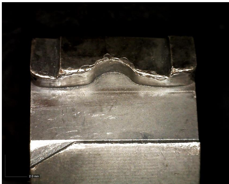
Εικόνα 7.32: Περιοχη διαμορφωσης – κεφαλη σιαγονας (AP) – συναρμολογημα QT+N2 (20x Μεγέθυνση).
