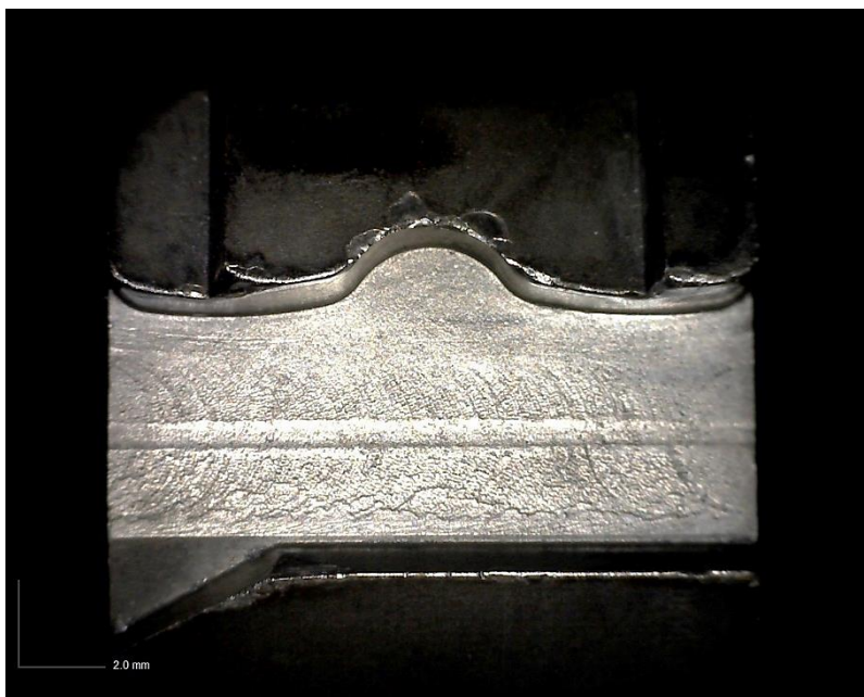
Εικόνα 7.20: Περιοχή διαμόρφωσης – κεφαλή σιαγόνας (AP) – συναρμολόγημα N (20x μεγέθυνση).
