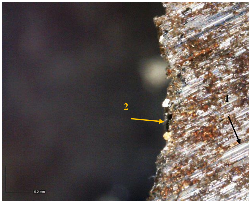
Εικόνα 7.7: Ακμή διαμόρφωσης του εργαλείου – περιοχή δημιουργίας θλιπτικής ίνας – συναρμολόγημα Parent Assembly (230x μεγέθυνση).
