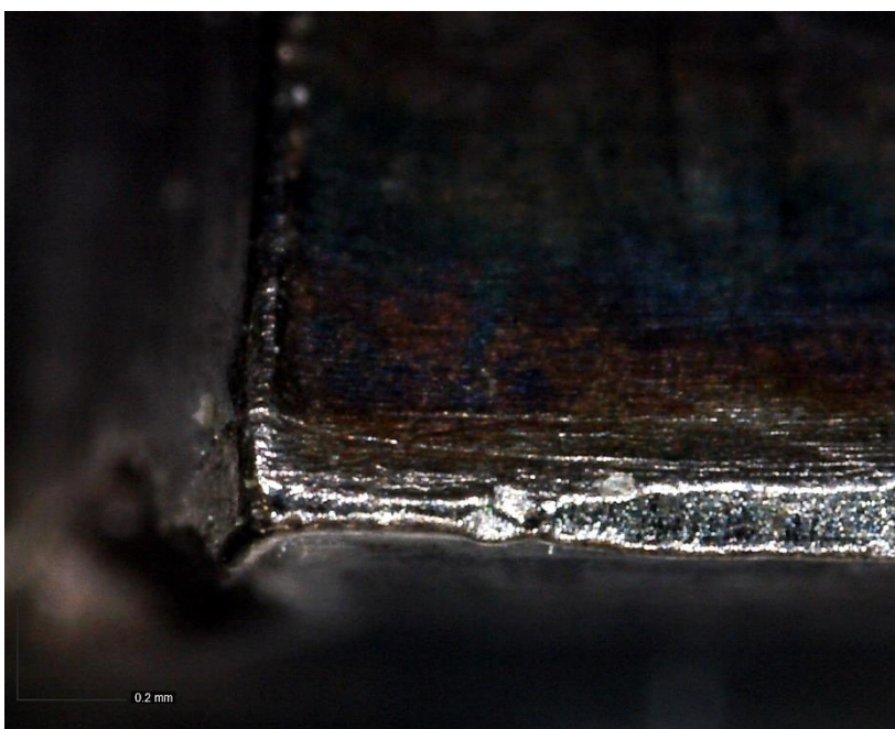
Εικόνα 7.15: Ακμή διαμόρφωσης εργαλείου – περιοχή δημιουργίας εφελκυστικής ίνας – συναρμολόγημα 1 st (230x μεγέθυνση).
