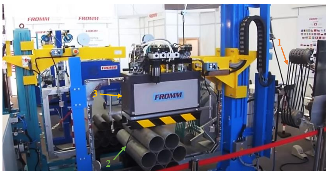
Εικόνα 4.4: Λεπτομέρειες συσκευής συνάρμωσης μεταλλικού ελάσματος [43].
