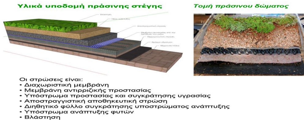
Εικόνα 7 - Διαστρωμάτωση φυτεμένου δώματος
