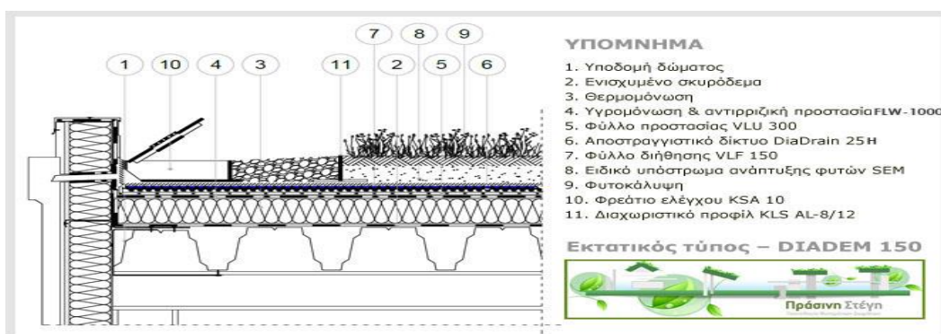
Εικόνα 11 - Τομή εκτακτικού τύπου Πηγή εικόνας: ( https://www.prasinistegi.gr )
