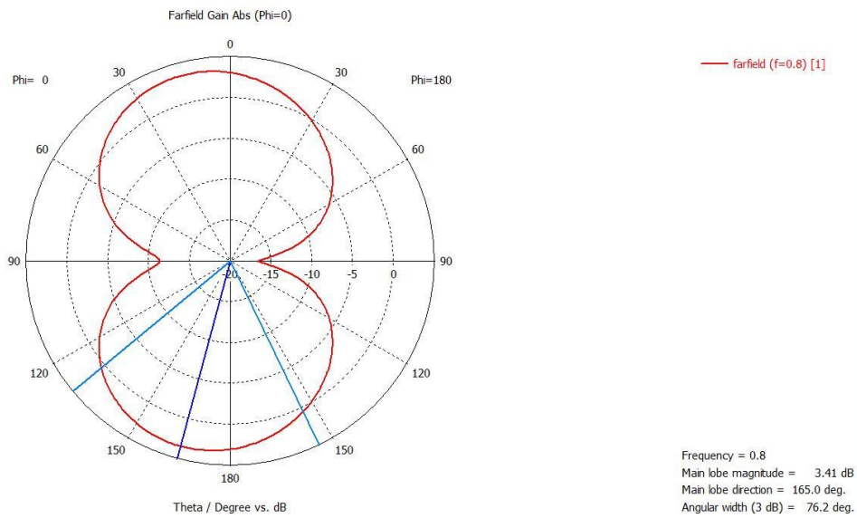
Εικόνα 120. Διάγραμμα Polar για Phi=0° (Unmirror 1 port 5 mm b-k l-2)
