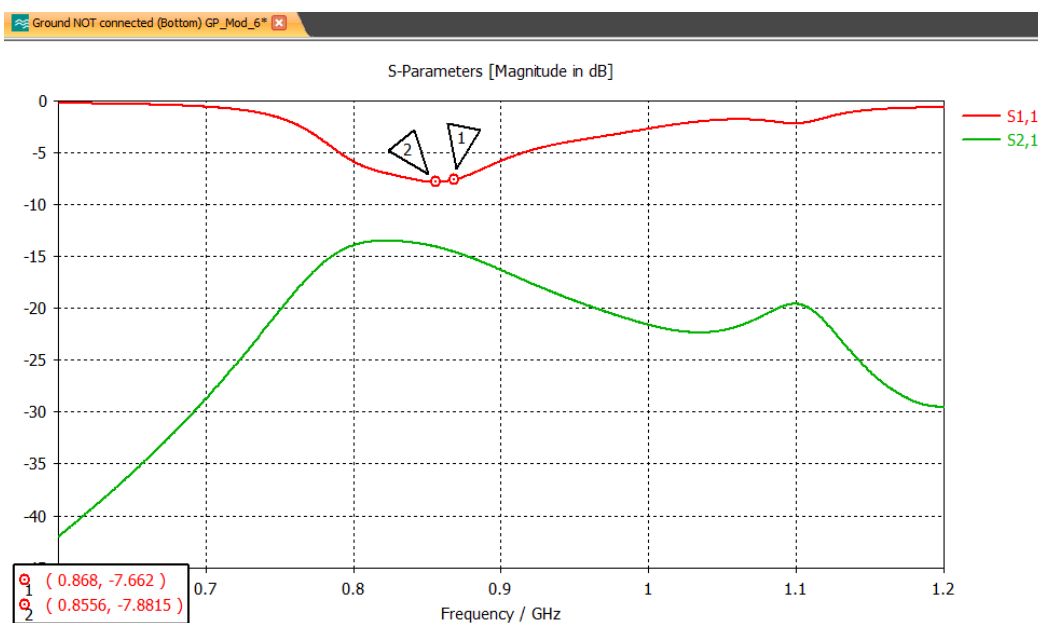
Εικόνα 294. S-parameters (Ground NOT connected (Bottom) GP_Mod_6)
