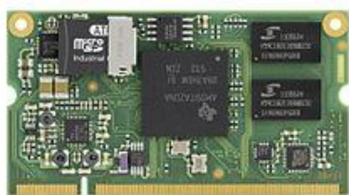
Εικόνα 1 Ένα ενσωματωμένο σύστημα σε μια κάρτα plug-in με επεξεργαστή, μνήμη, τροφοδοτικό και εξωτερικές διεπαφές [1]
