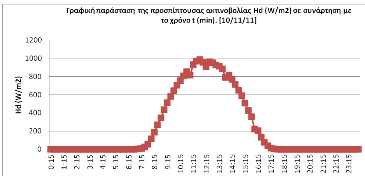
Σχήμα 27: Γραφική παράσταση της προσπίπτουσας ακτινοβολίας H_d (W/m 2 ) σε συνάρτηση με το χρόνο t (min)
