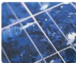
Εικόνα 4 Φωτοβολταϊκά κελιά πολυκρυσταλλικού πυριτίου (MultiCrystalline Silicon, mc-Si)
