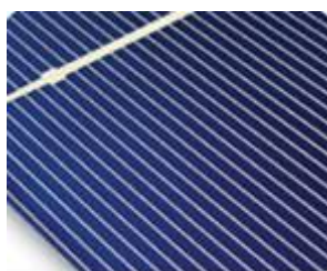
Εικόνα 3 Φωτοβολταϊκά στοιχεία μονοκρυσταλλικού πυριτίου (SingleCrystalline Silicon, sc-Si)
