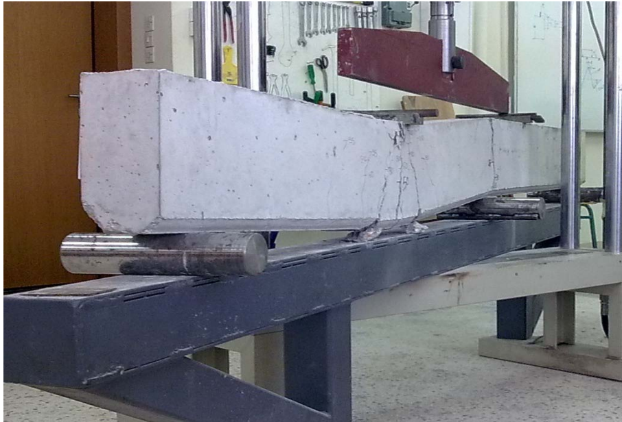
ΕΙΚ.15) Κατάρρευση 1ης μάρτυρας δοκού (P=120KN)
