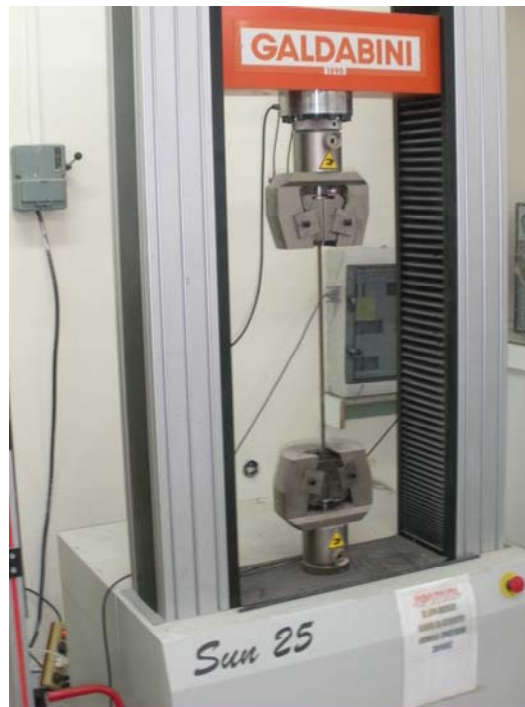
ΕΙΚ.6) Εφελκυσμός χάλυβα στο Εργαστήριο οπλισμένου σκυροδέματος ΤΕΙ ΠΕΙΡΑΙΑ
