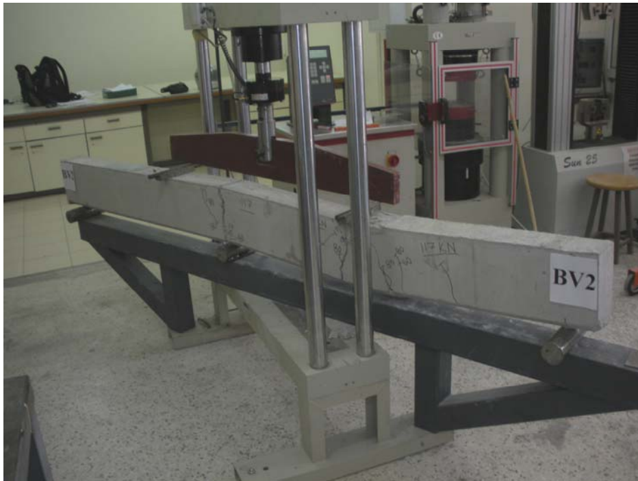
ΕΙΚ.15) Κατάρρευση 1ης μάρτυρας δοκού (P=120KN)
