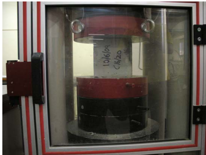
ΕΙΚ.5) Το δοκίμιο θλίβετε στη πρέσα
