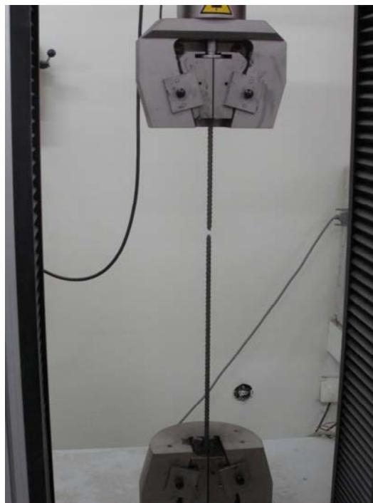
ΕΙΚ.7) Θραύση δοκιμίου στο μέσον του
