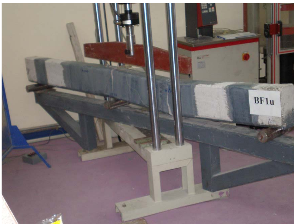
ΕΙΚ.31) Κατάρρευση 2 ης ενισχυμένης δοκού
