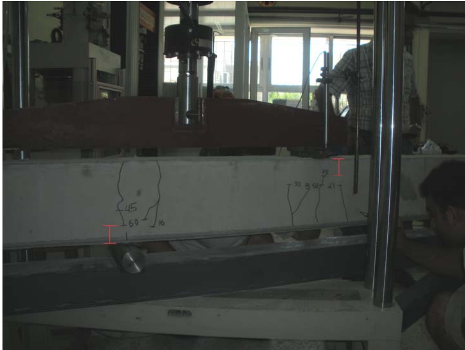
ΕΙΚ.13) Εμφανείς οι καμπτικές ρωγμές αλλά και το ύψος της θλιβόμενης ζώνης. Η δοκός βρίσκεται στην ελαστική περιοχή. (P=75KN)
