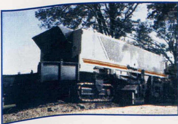
CR 4500 Μηχάνημα ανακύκλωσης ασφαλτικού υλικού οδών με μέγιστο φάρδος 4,5 μέτρα π.χ εθνικές οδοί.
