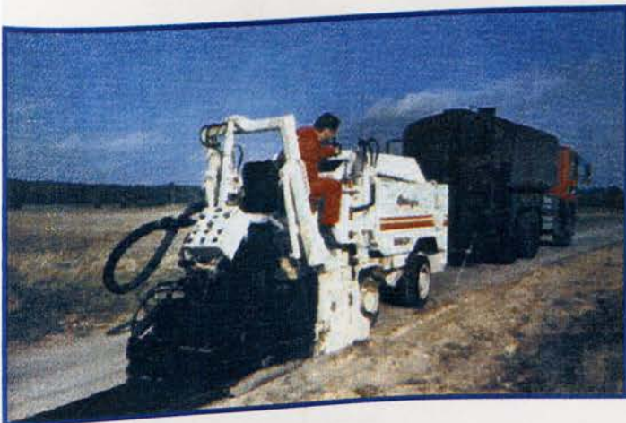
1000 CR μηχάνημα ανακύκλωσης ασφαλτικού υλικού, οδών αραιής κυκλοφορίας.
