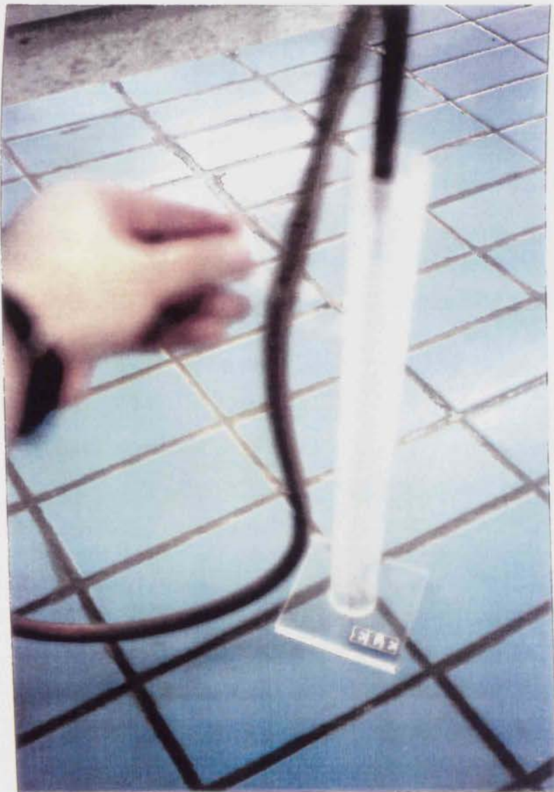
Φ. 83. Πίεση του δαχτυλιδιού του αρδευτικού σωλήνα για την ροή διαλύματος στο υλικό που βρίσκεται μέσα στον ογκομετρικό κύλινδρο ELE.
