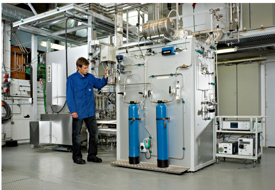
Εικόνα 38. Κυψέλη καυσίμου στερεών οξειδίων 5kW της εταιρείας Apros.
