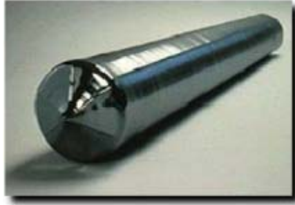
Σχήμα 3.8: Μονοκρυσταλλικοί ράβδοι Si
