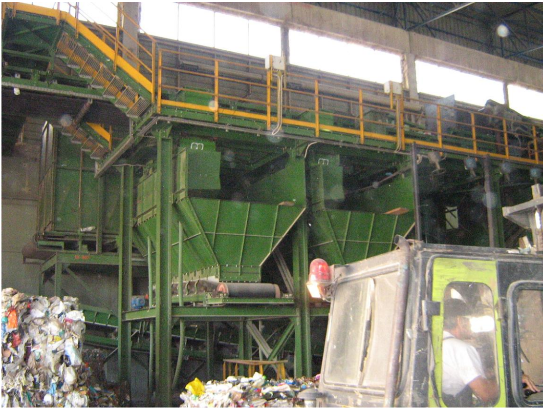
Εικόνα 30. Σύστημα διαχωρισμού πλαστικών μπουκαλιών του ΕΜΑΚ
