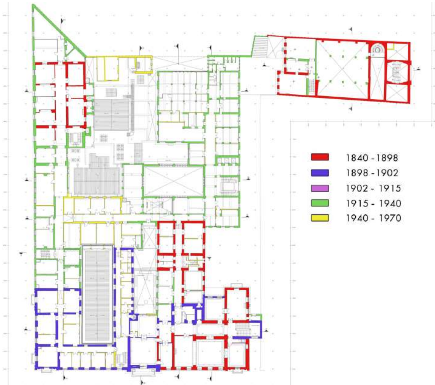
Εικόνα 37. Στάθμη Α Ορόφου. Ανάλυση Οικοδομικών φάσεων και ανάπτυξης του κτιρίου.
