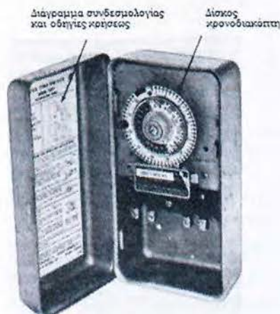
Ψυκτικές μηχανές και εγκαταστάσεις, σελίδα 418. Σχήμα 6.4α. Χρονοδιακόπτης κατάλληλος για έλεγχο αποπάγωσης.
