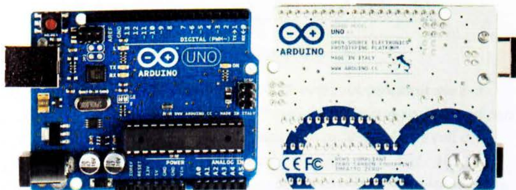
Σχήμα 17 Εμπρόσθια και πίσω εικόνα του Arduino Uno Rev3
