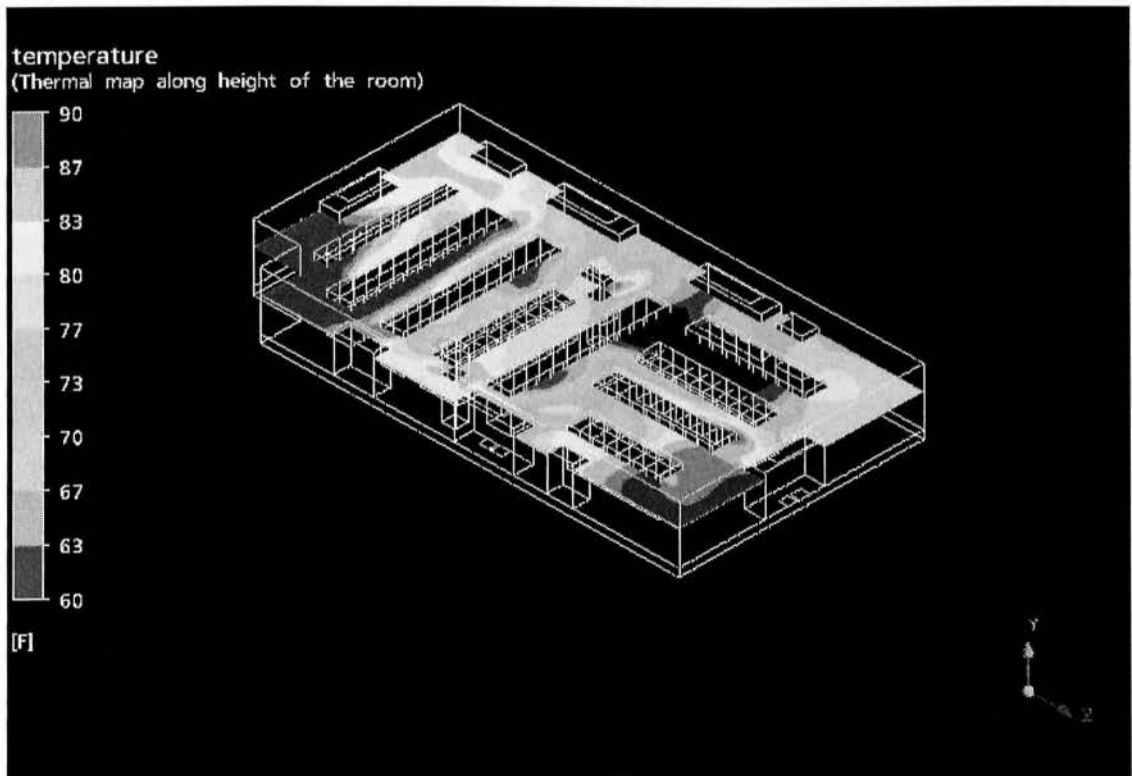
2.10 Θερμοκρασιακή κατανομή εσωτερικού χώρου με λογισμικό fluent .
