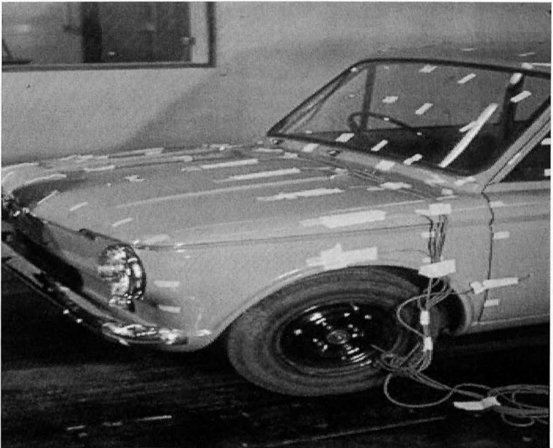
2.2 Τοποθέτηση αισθητήρων στο υπό μελέτη αυτοκίνητο στα επιθυμητά σημεία όπου θέλουμε να πάρουμε μετρήσεις πίεσης θερμοκρασίας κτλ.
