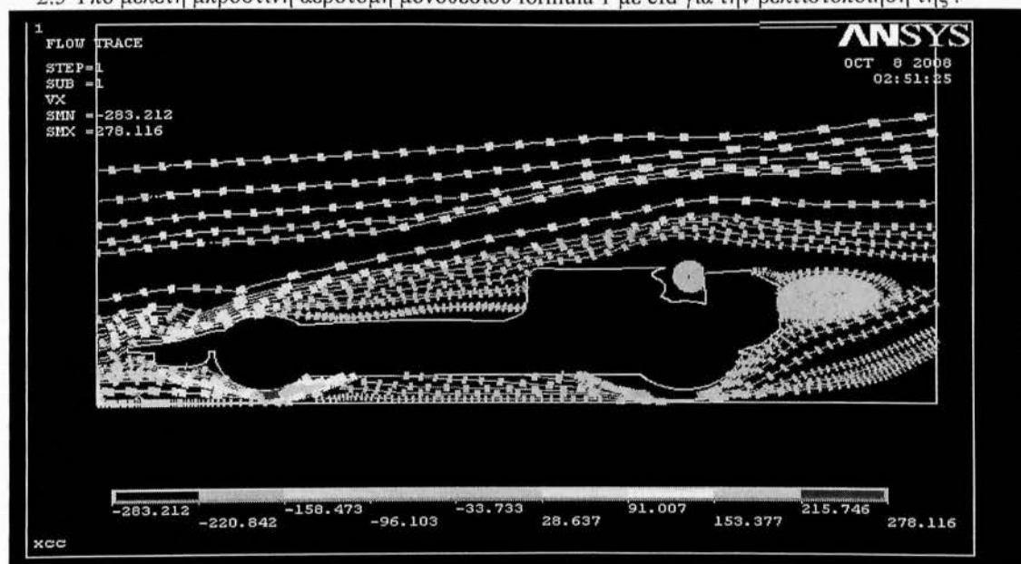
2.6 Μελέτη ροής αέρα γύρω από ένα μονοθέσιο.
