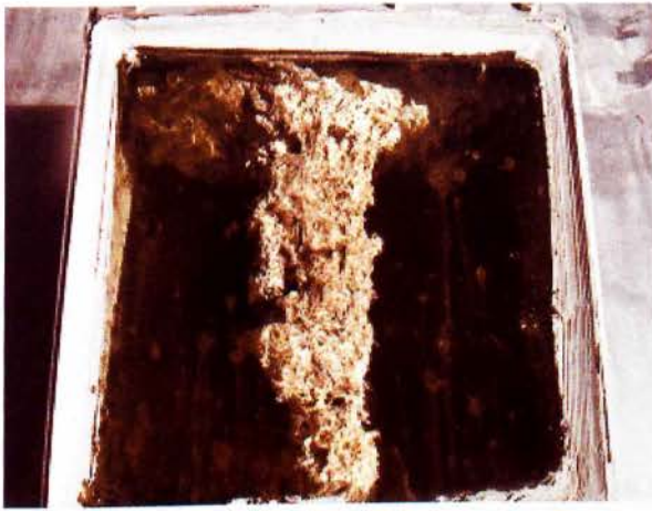
Σχήμα 2.8: Στοιχειακό θείο, που προκύπτει από βιολογική αποθείωση μέσα στο χωνευτήρα
