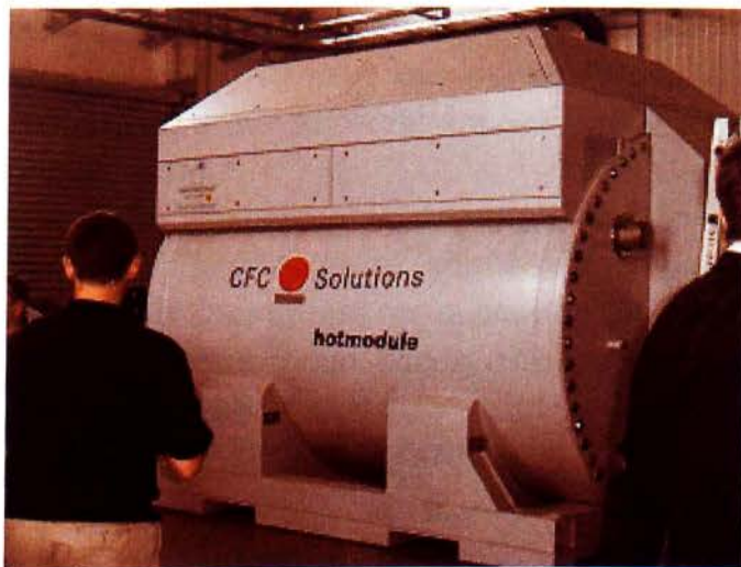
Σχήμα 4.5: Η πρώτη παγκοσμίως κυψέλη καυσίμου τύπου MCFC για βιοαέριο, που λειτουργεί στη Γερμανία [33]
