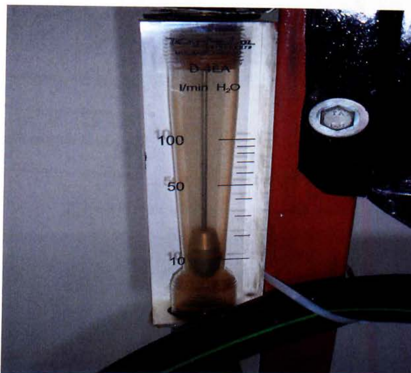
Σχήμα 3.5: Η χρησιμοποιούμενη βάννα για τη ρύθμιση της ροής του νερού και το ροόμετρο.
