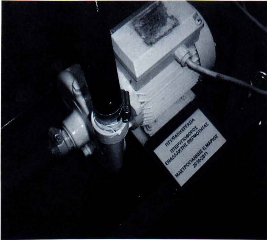
Σχήμα 3.4: Η αντλία του κυκλώματος. Κατάλληλη για χρήση ζεστού νερού θερμοκρασίας T_{max}=85^{\circ}C
