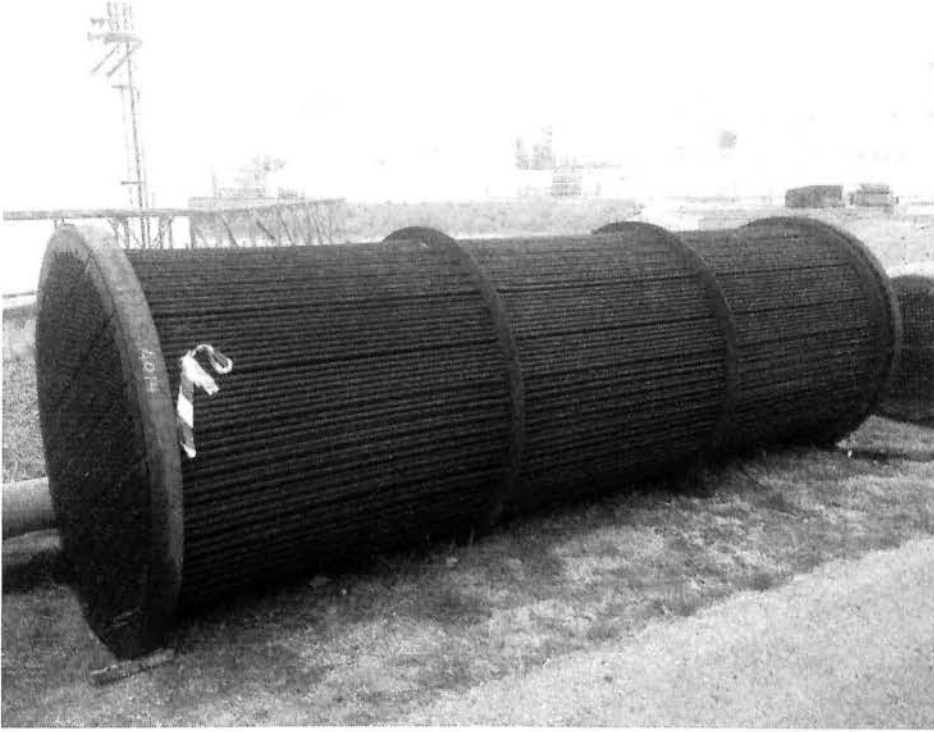
Σχήμα 4.10: Δέσμες αυλών στον χώρο συντήρησης και κατά την τοποθέτηση στην μονάδα.
