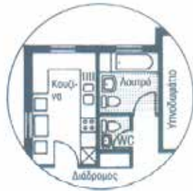
7 Κουζίνα, λουτρό και WC με καινό τοίχο εγκαταστάσεων
