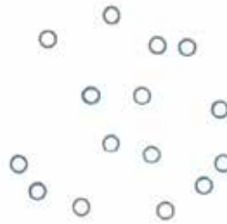
ΣΧΗΜΑ 11. ΑΤΟΜΙΚΗ ΚΑΤΑΣΤΑΣΗ ΜΕΤΑΛΛΟΥ ΣΕ ΥΓΡΗ ΜΟΡΦΗ. (10)
