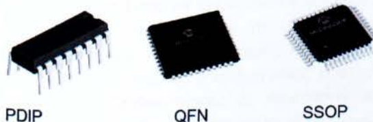
Εικόνα1.4:Διαφορετικοί τύποι συσκευασιών PIC
