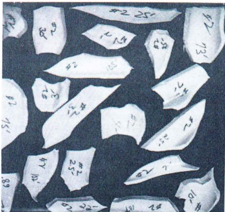
ΕΙΚ.4.15 Θραύσματα των PVC σωλήνα Ο πρώτος αριθμός είναι ενδεικτικός της αλληλουχίας δοκιμής, ο δεύτερος αριθμός είναι η απόσταση από το σημείο της δοκιμής όπου το θραύσμα ανακτήθηκε.
