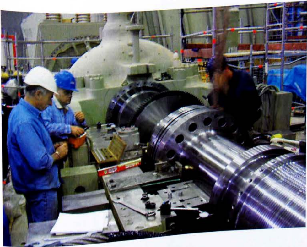
Εικ. 66. Μέτρηση οπών βιδών σύζευξης
