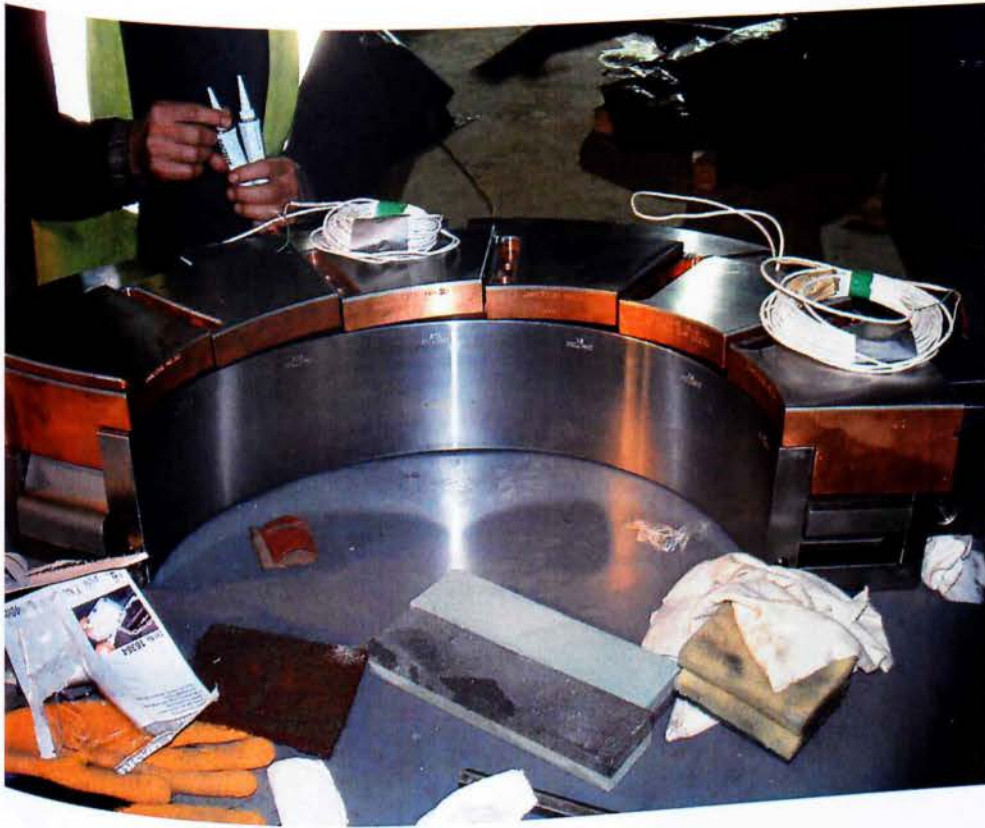
Εικ. 57. Συναρμολόγηση ανακλινόμενων βάσεων ωστικού κουζινέτου με καλώδιο
