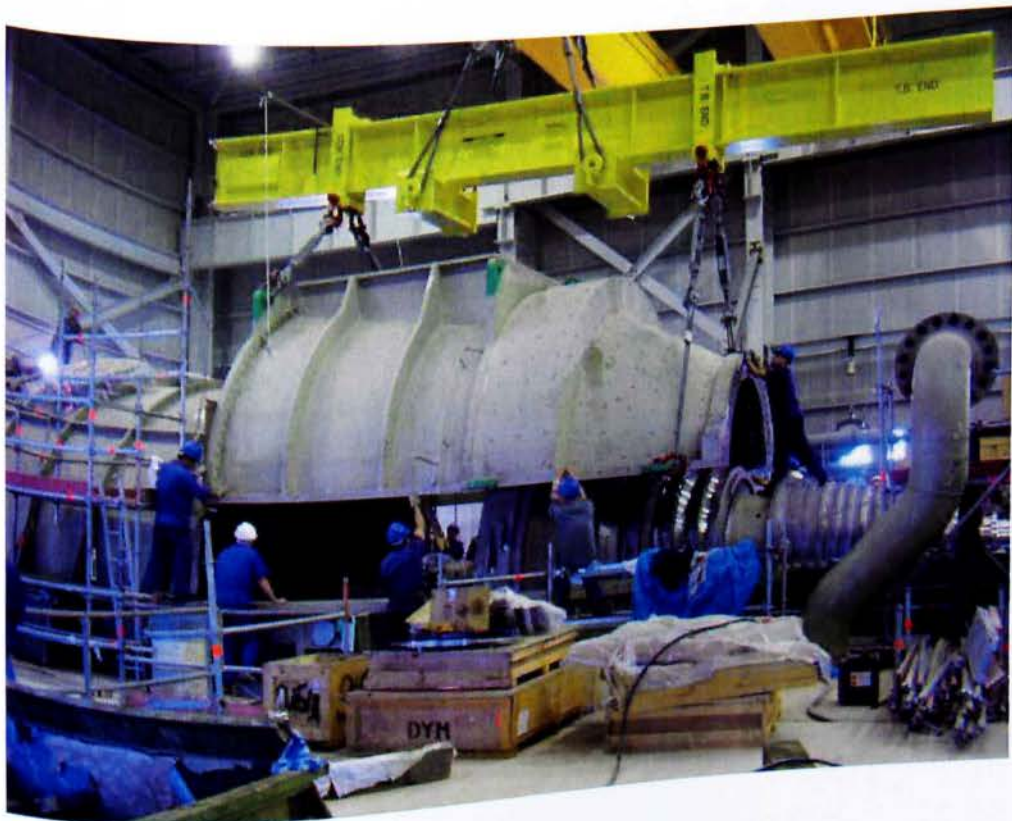
Εικ. 71. Συναρμολόγηση, ανύψωση (συναρμολογημένου) άνω μισού ΧΠ/ κελυφών κυλίνδρου ΧΠ
