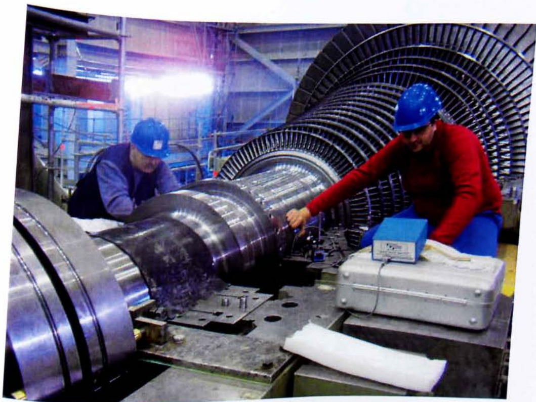
Εικ. 68. Έλεγχος ευθυγράμμισης δίοδου ατμού με τη χρήση ERAG
