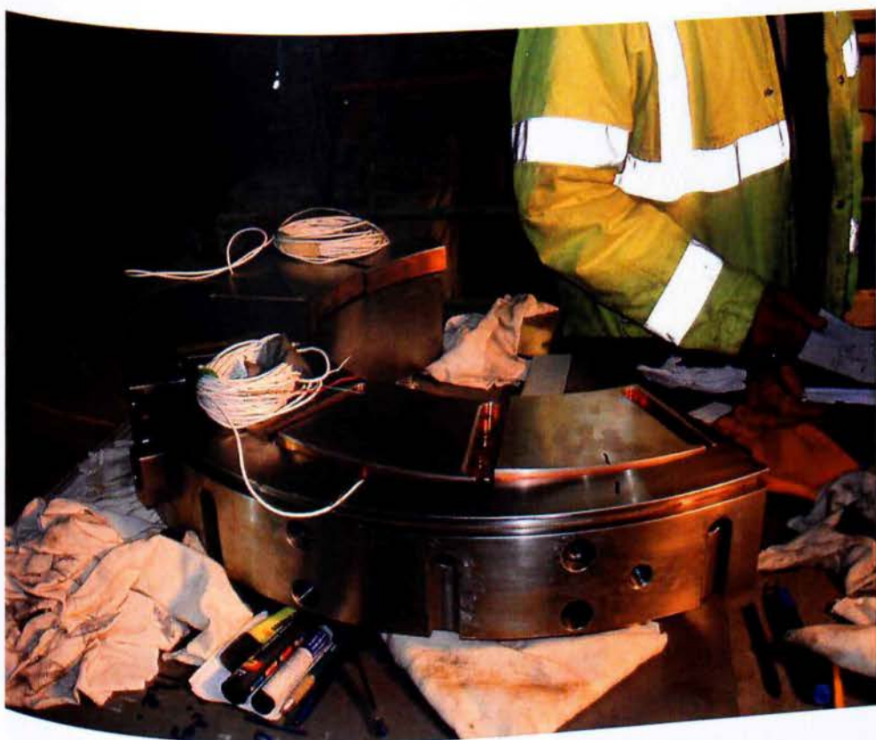
Εικ. 58. Σύνδεση καλωδίου στις βάσεις των ωστικών κουζινέτων
