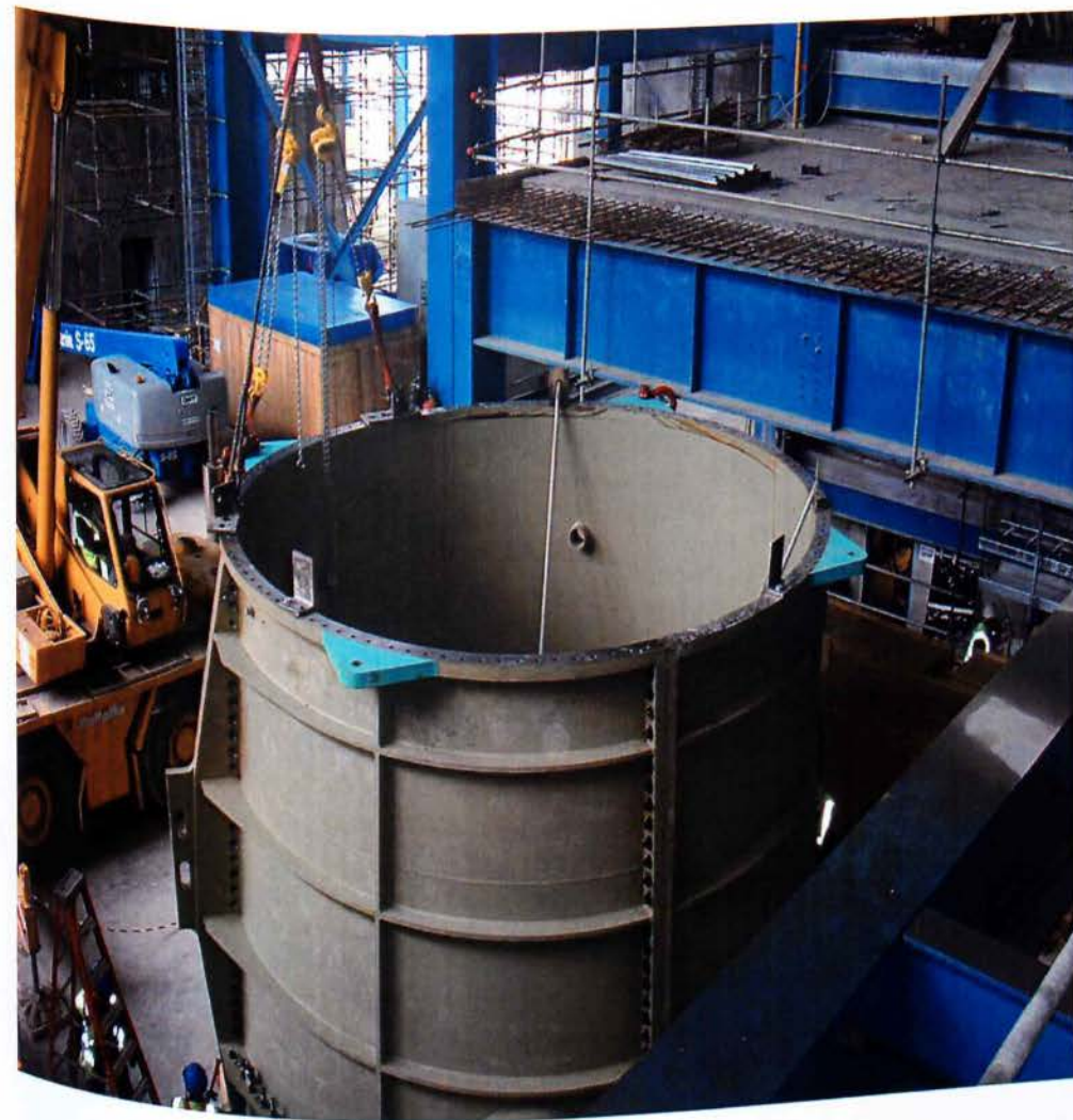
Εικ. 47. Συναρμολογημένος αγωγός διάχυσης εξάτμισης
