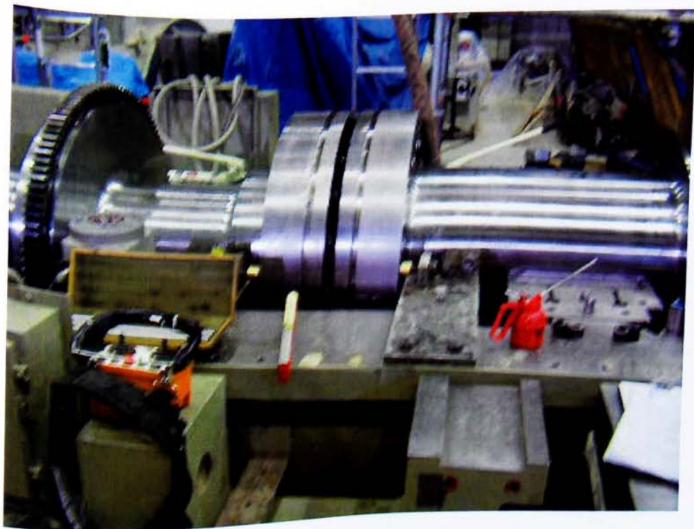
Εικ. 67. Ευθυγράμμιση ομφαλών σύζευξης στα σημεία συνένωσης ή στα ανώτατα σημεία
