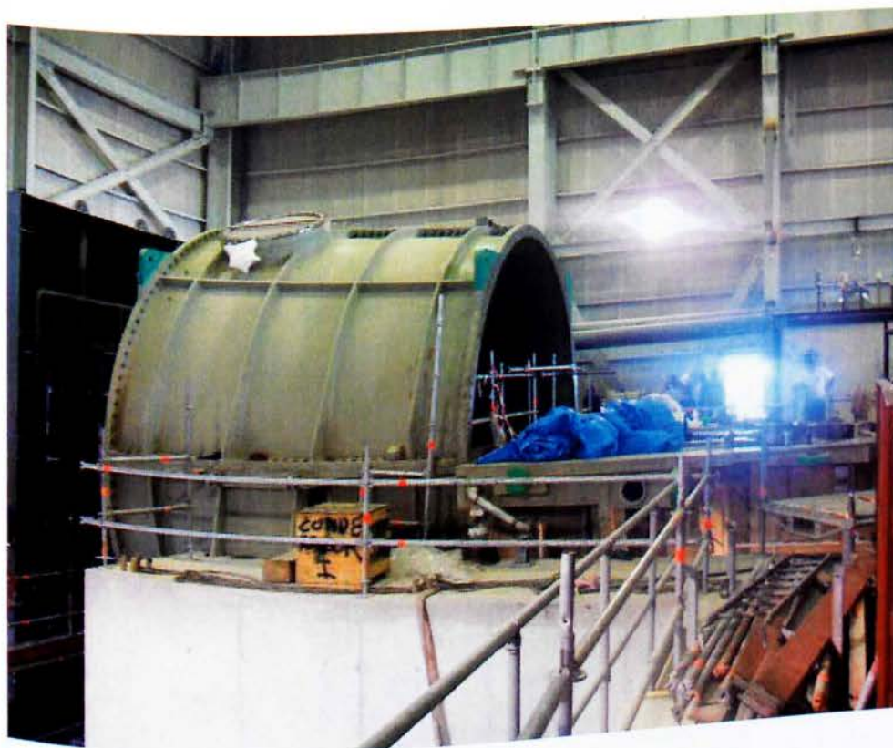
Εικ. 48. Διαχύτης τοποθετημένος σε στηρίγματα θεμελίωσης/κάθετες βίδες
