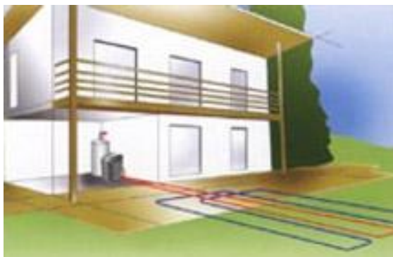
Σχήμα 4.6 - Οριζόντιο κλειστό γεωθερμικό σύστημα
