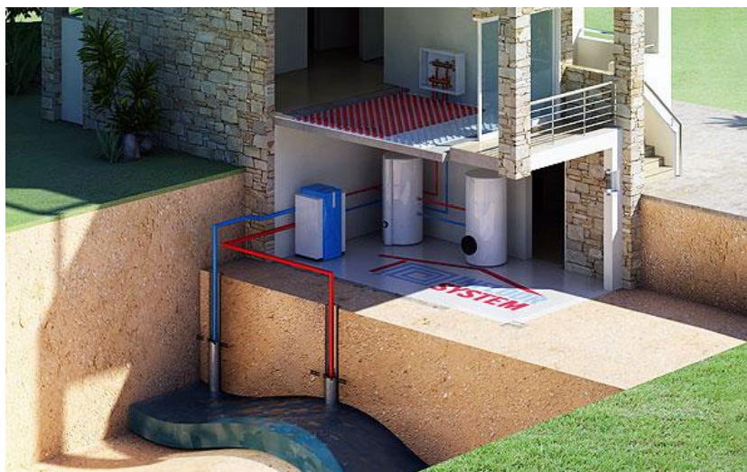
Σχήμα 4.8 - Γεωθερμικά συστήματα ανοιχτού κυκλώματος
