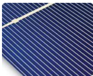
Σχήμα 3.34 - φωτοκυψέλη μονοκρυσταλλικού πυριτίου
