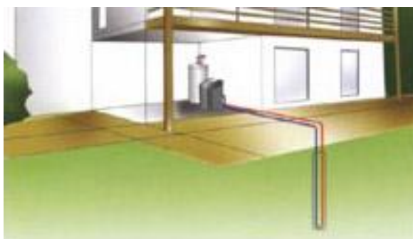
Σχήμα 4.7 - Κατακόρυφο κλειστό γεωθερμικό σύστημα
