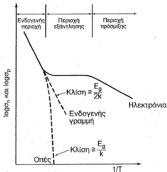
Σχήμα 3.5: Μεταβολή της ηλεκτρικής αγωγιμότητας ενός εξωγενούς ημιαγωγού σε συνάρτηση με τη θερμοκρασία
