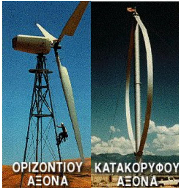
Σχήμα 3.6: Συστήματα αιολικής ενέργειας οριζοντίου και κατακόρυφου άξονα
