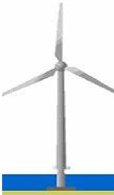
Σχήμα 3.10: Ο δεύτερος τύπος κατασκευής από μεταλλικό σωλήνα.
