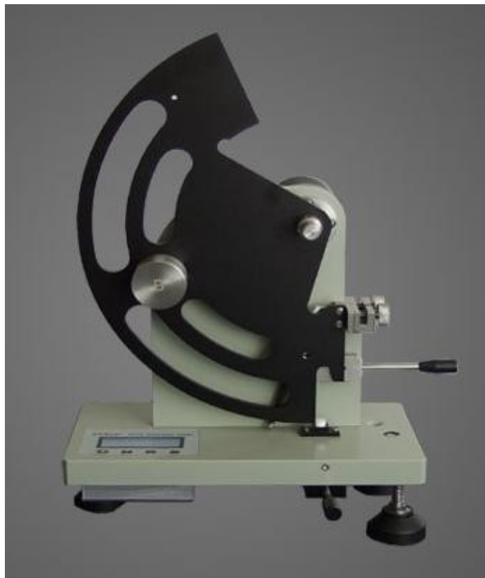
Εικόνα 6.11.: Η συσκευή Elmendorf για το τεστ σκισίματος.
