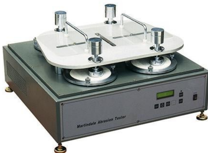
Εικόνα 6.3.: Συσκευή Martindale για το τεστ τριβής.
