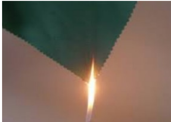
Εικόνα 5.9.: Τεστ καύσεως σε ύφασμα.
