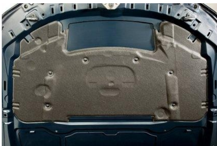
Εικόνα 3.7.: Ύφασμα για την απορρόφηση των θορύβων του κινητήρα κάτω από το καπό.
