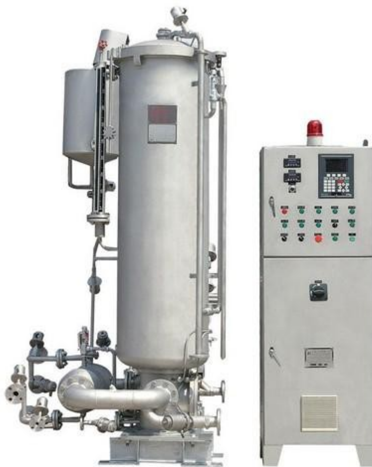
Εικόνα 4.2.: Μηχανή βαφής νημάτων σε μπομπίνες. Στο εσωτερικό της διαθέτει κάθετους διάτρητους κυλίνδρους για την τοποθέτηση των προς βαφή μπομπινών.
