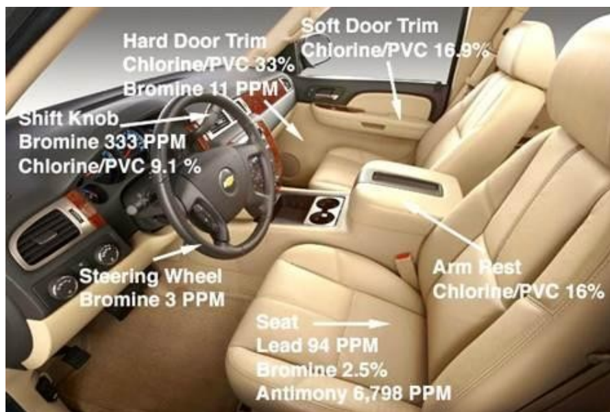
Εικόνα 7.1.: Τα υλικά από διάφορα εξαρτήματα του εσωτερικού με αναφορά στα στοιχεία που προκαλούν πρόβλημα στην ανακύκλωση και το περιβάλλον.
