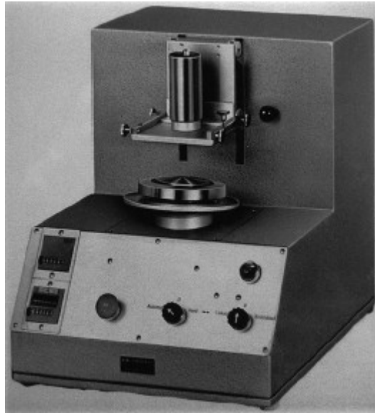
Εικόνα 6.4.: Συσκευή Schorpper για το τέρστ τριβής.
