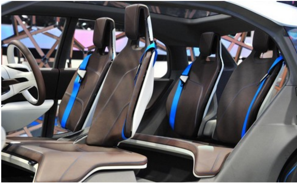
Εικόνα 8.3.: Τα καθίσματα του Bmw i3. Αποτελούνται από ύφασμα, και το πλαίσιο (παραδοσιακά σιδερένιο) του καθίσματος έχει αντικατασταθεί πλήρως από το πλαστικό τμήμα που βρίσκεται στο πίσω μέρος του.
