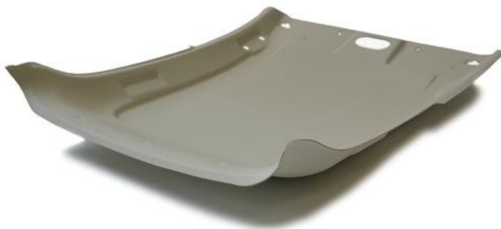
Εικόνα 2.7.: Μία απλή ταπετσαρία οροφής σύγχρονου αυτοκινήτου από μη-υφάνσιμο ύφασμα.
