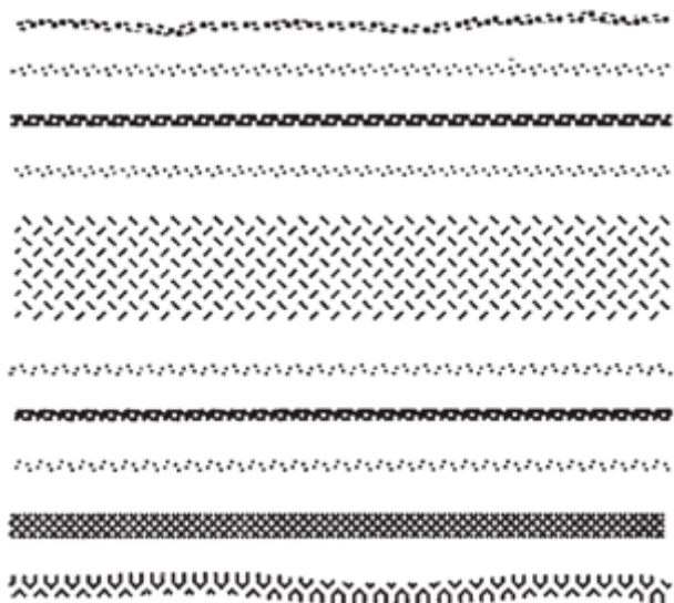
Εικόνα 2.8.: Οι στρώσεις υλικών στην ταπετσαρία (από πάνω προς τα κάτω):μη-υφάνσιμο ύφασμα ως πλαίσιο, κολλητικό φιλμ, ίνες γυαλιού, κεντρικός πυρήνας, κολλητικό φιλμ, ίνες γυαλιού, αφρός πολουρεθάνης, διακοσμητικό ύφασμα.
