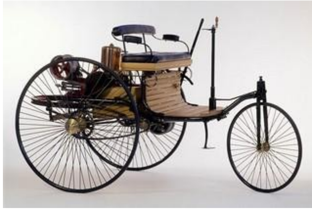
Εικόνα 1.1.: Το πρώτο αυτοκίνητο (Benz Patent Motor Car), από τον Karl Benz. Τα κλωστοϋφαντουργικά υλικά περιορίζονταν μόνο στο κάθισμα του οδηγού και τα ελαστικά των τροχών.
