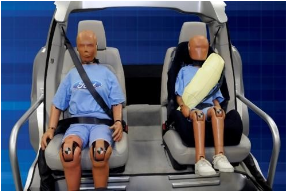
Εικόνα 3.1.: Στα αριστερά βρίσκεται μία συμβατική ζώνη και στα δεξιά, μία ζώνη με ενσωματωμένο αερόσακο.
