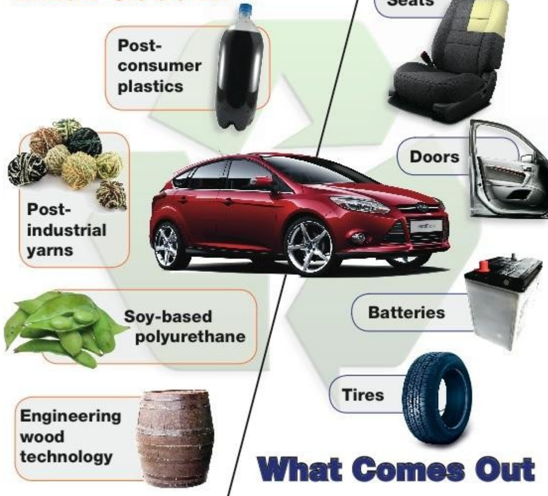
Εικόνα 7.2.: Υλικά που ανακυκλώνονται και τα υλικά που προκύπτουν για την κατασκευή ενός οχήματος. [7]
