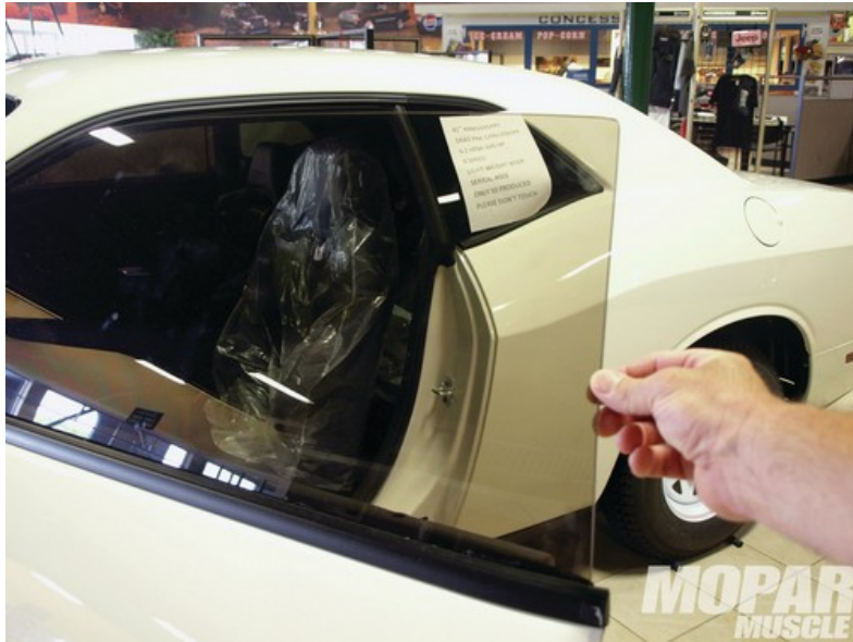
Εικόνα 8.4.: Επιφάνεια από πλαστικό με πολλά άτομα άνθρακα (Polycarbonate Plastic). Το βάρος του είναι αρκετά μικρότερο από του γυαλιού.
