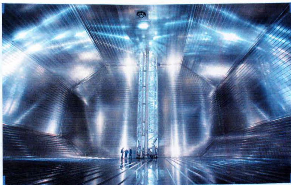
Τομή δεξαμενής τύπου Moss, φορτηγού πλοίου.
