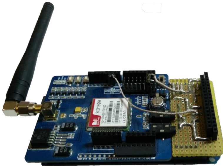
Εικόνα 2.13: Συνδυασμός GSM και κυκλώματος υπέρυθρων
