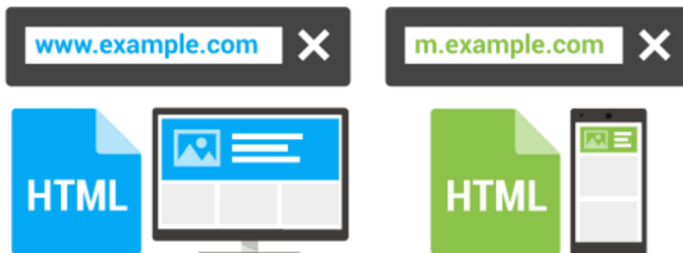
Εικόνα 5.6: Διαφορετικές διευθύνσεις URL για την εξυπηρέτηση χρηστών από επιτραπέζιο υπολογιστή και κινητές συσκευές[28].
