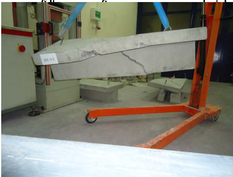
Σχήμα 2. Αστοχία πλακοδοκού σε στρέψη
