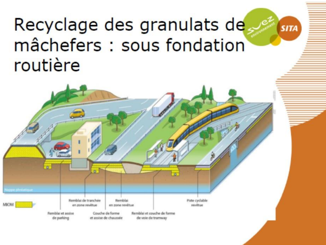
Εικόνα 17 . Χρήση σκωριών για έργα υποδομής [17]
